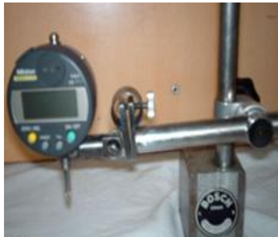
Figure III.12. Dispositif de mesure de l'usure en cratère.
