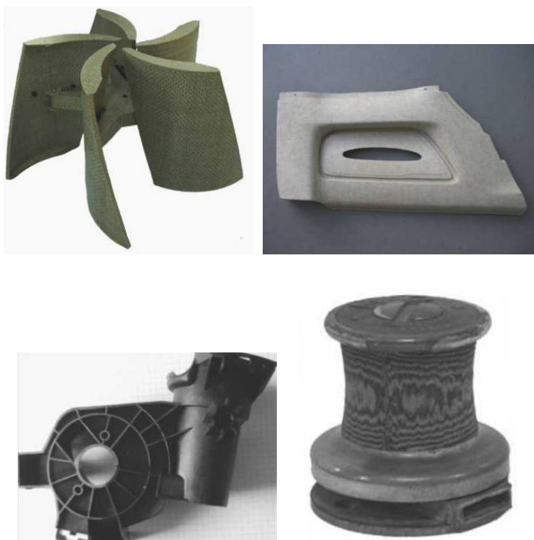
Figure I-17 : Réalisation des pièces renforcées par des fibres végétales [BAL-13]
