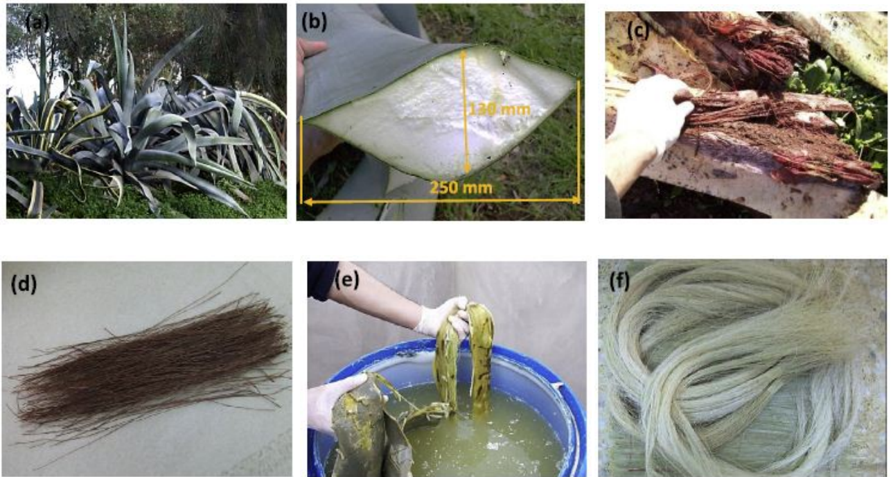
Figure I.24 : (a) Exemple des fibres Agave americana L. de la région de Guelma (Algerie), (b) section de la plante (c) Extraction après 90 jours; (d) fibres obtenues. (e) Fibres d'Agave par immersion dans l'eau 10 à 13 jours; (f) fibres obtenues.
