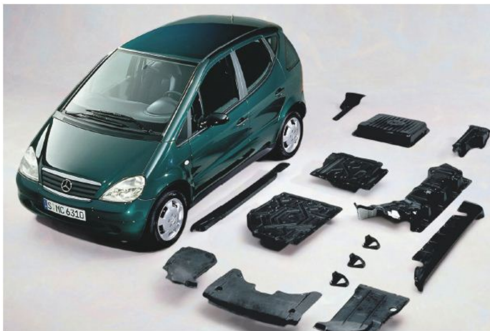
Figure I-16 : Des pièces renforcées par des fibres végétales (Flax/polypropylène) Mercedes Benz A-Class. [GEO-03]
