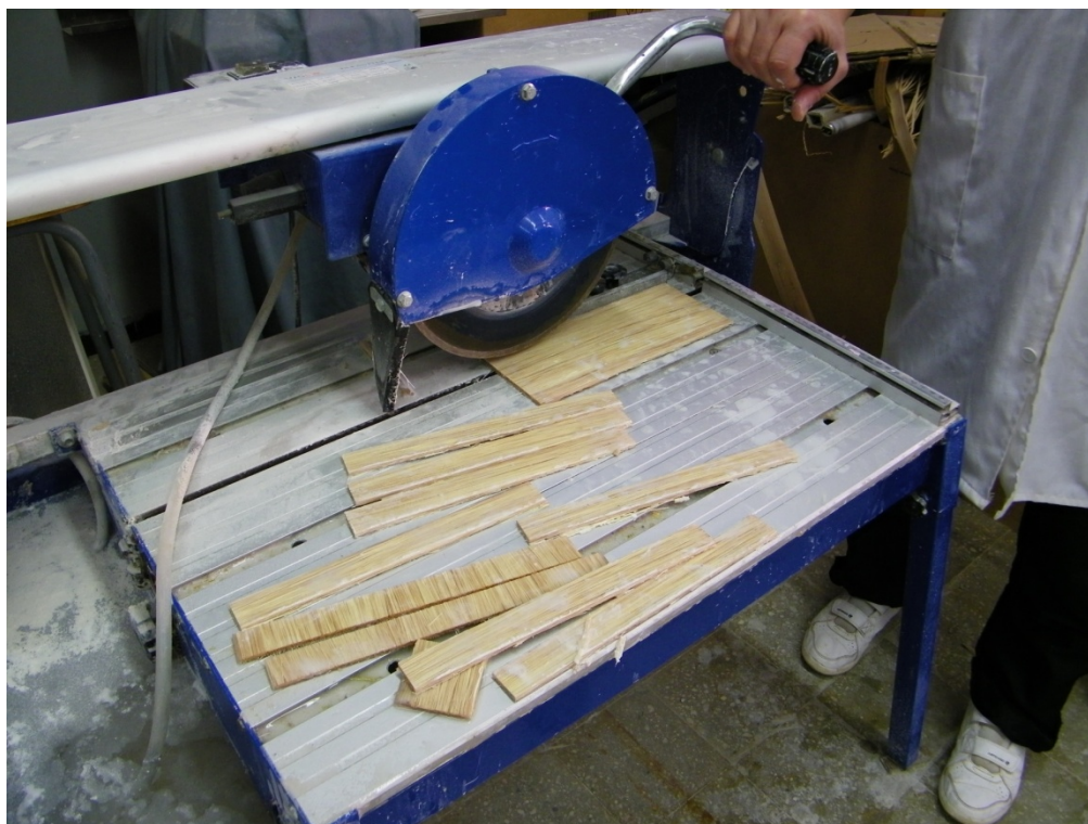
Figure II.15 : Tronçonneuse à disque en diamant utilisée pour la découpe des plaques stratifiées.
