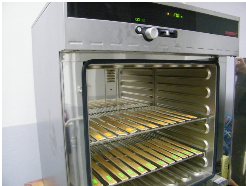
Figure II.17 : Etuve à commande digitale d'un modèle memmert
