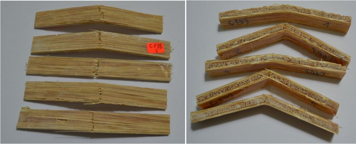
Figure III.28 : Rupture des stratifiés : (a) 2 plis unidirectionnels (b) 4 plis croisés.
