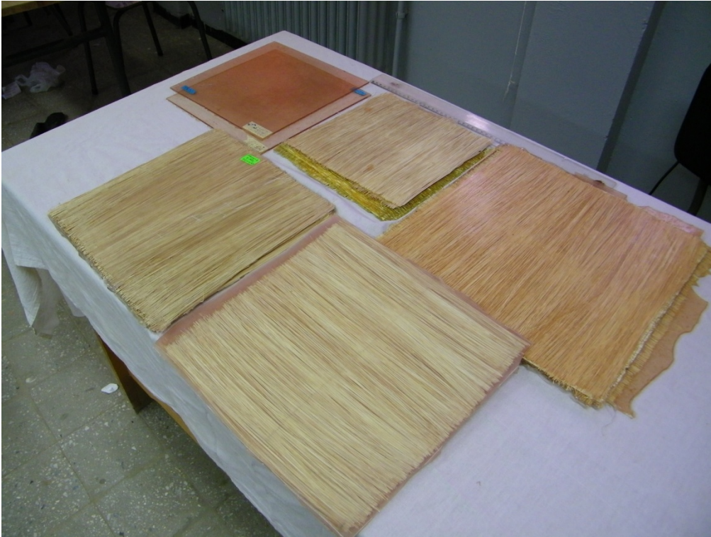
Figure II.6 : Plaques stratifiées bio-composites fabriquées.
