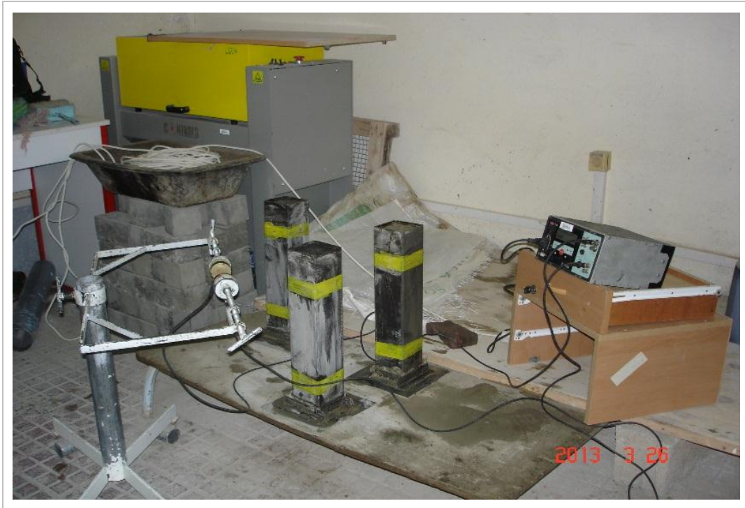
Figure III.3.b- Dispositif utilisé pour la caractérisation ultrasonique de la ségrégation (LGCH, université de Guelma, Algérie)
