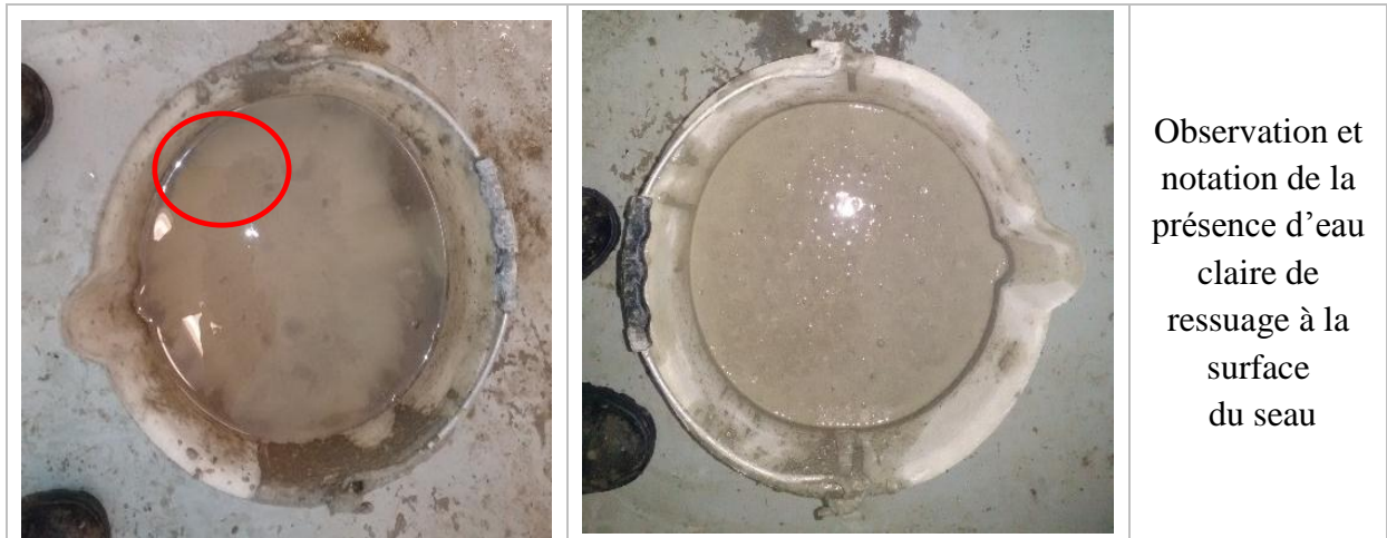
Figure III.1.a- Essai au tamis et critère de stabilité (ressuage à la surface)
