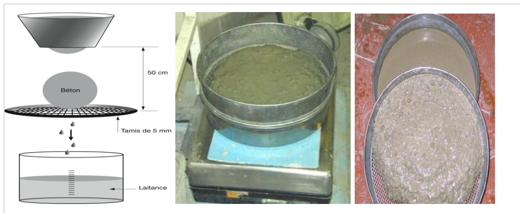
Figure I.26- Essai de stabilité au tamis
