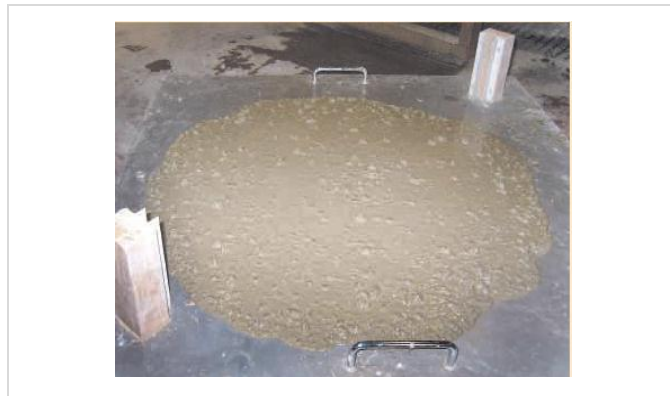
Figure I.9- Essai d'étalement au cône d'Abrams
