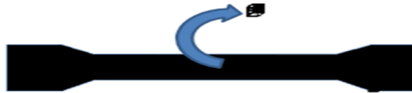
Figure2.1. L'échantillon de PA66 prélevé au milieu de l'éprouvette.
