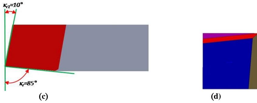
Fig. 2. Géométrie d'outil de tournage pour \gamma_p=0^\circ .
