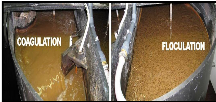
Figure 7 : Le procédé de Coagulation / Flocculation
