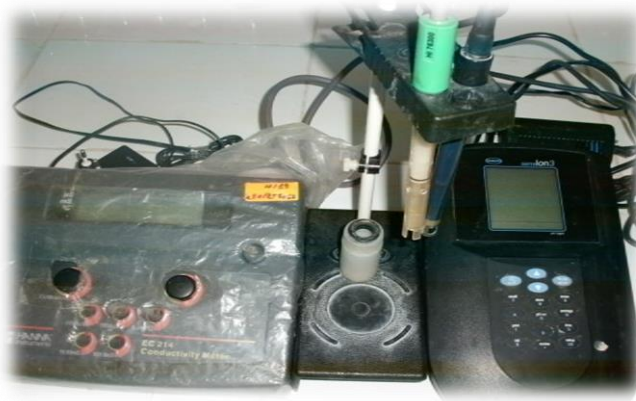
Figure 35 : un pH mètre (à droite) et un conductimètre (à gauche)
