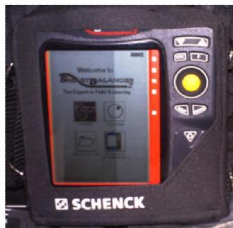
**Figure II.10** Vibromètre (Smart Balancer 2).
