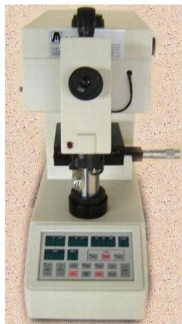
**Figure II.3** Duromètre digital type DM2-D 390.
