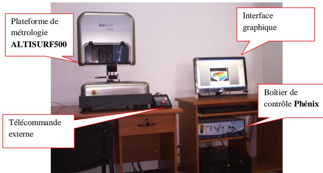
**Figure II.6** Station de métrologie optique Altisurf 500.
