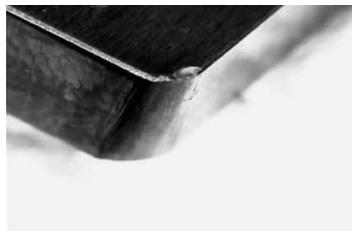
**Figure I.9** L'usure par écaillage [LIU 02].
