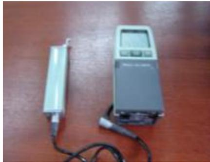
**Figure II.5** Rugosimètre Mitutoyo Surftest 201.
