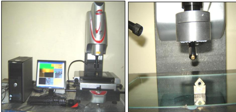
**Figure II.13** Microscope pour la mesure de l'usure
