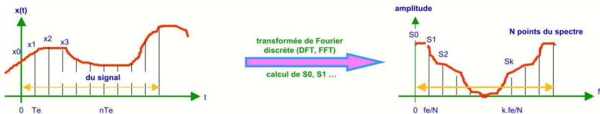
**Figure I.20** Transformée de Fourier discrète pour une réponse vibratoire.
