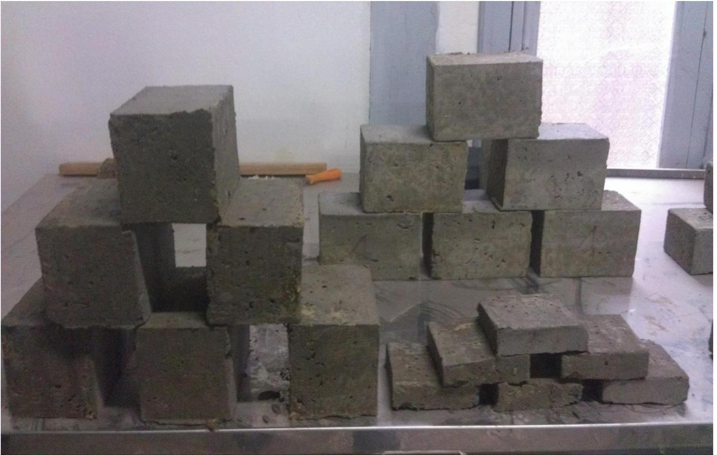
**Figure III.4 :** Dimensions d'éprouvettes testées
