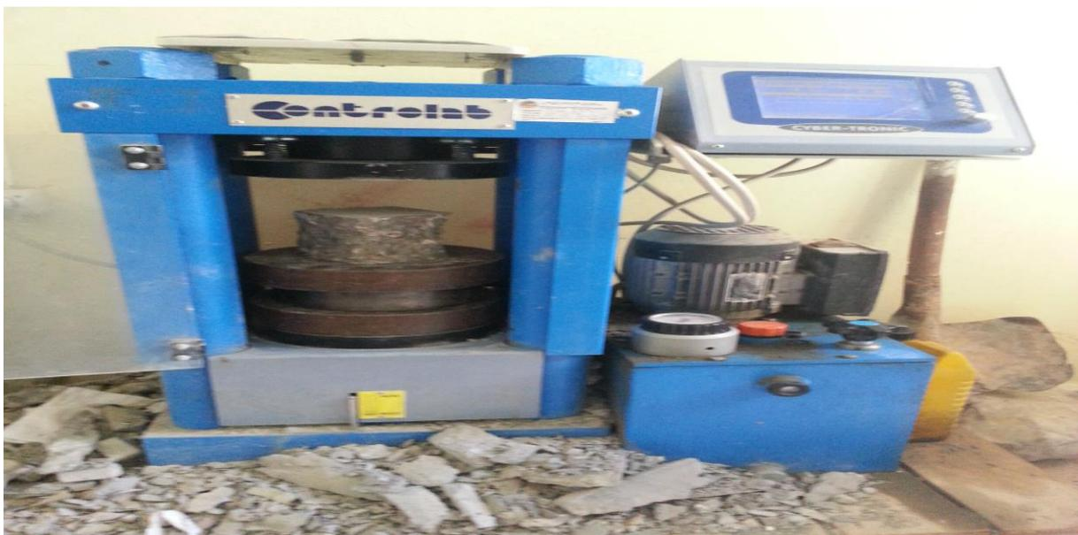
**Figure II.6** : machine d'écrasement (la presse) utilisée
