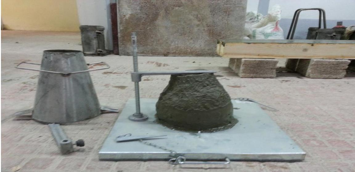
**Figure III.3 :** Essai d’affaissement
