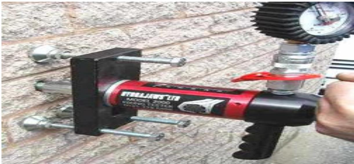
**Figure I.5:** Appareil d'arrachement
