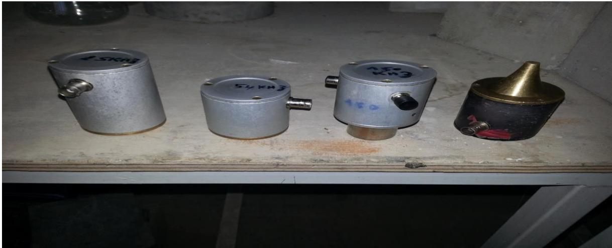
Figure II.2: Les transducteurs utilisés
