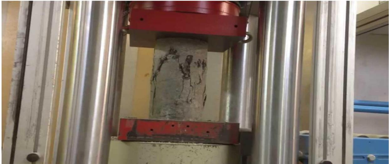
**Figure I.7 :** Essai de compression avec la presse
