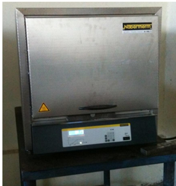
Figure II-3: Four à chambre électrique pour le traitement thermique des éprouvettes
