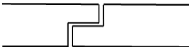
*Figure I.2.5 : Joint à feuillure.*
