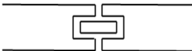
*Figure I.2.6 : Joint clavette.*
