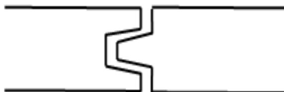
*Figure I.2.4 : Joint à emboîtement.*
