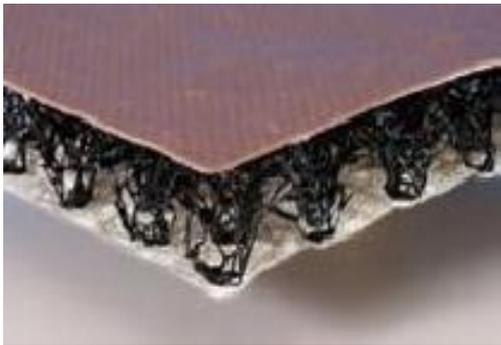
**Figure 2.2.A Structure géocomposite**
