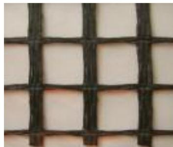
**Figure 2.14 Géogrille biaxiale.**
