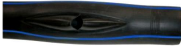
Figure II.6: Exemple d'un tube en PE endommagé
