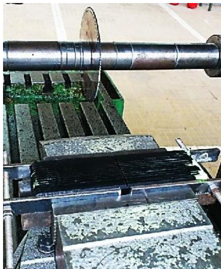
Figure II.17: réalisation des notchs
