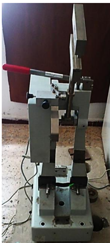
Figure II.27: Dispositif de l'essai de choc ZWIK 5113.
