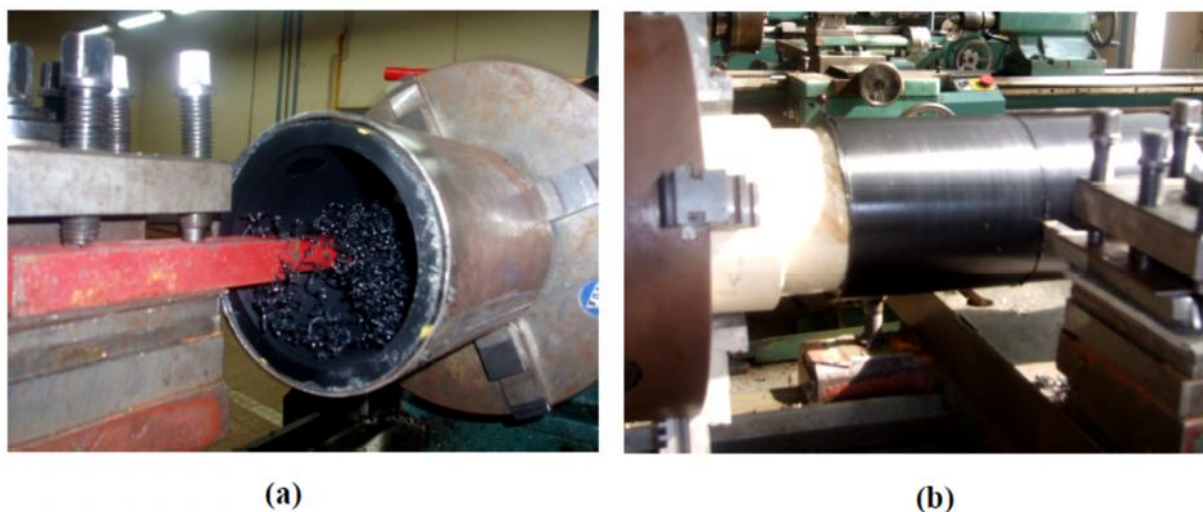
Figure II.12: Opérations de tournage du tube en PE 100: (a) alésage, (b) chariotage.
