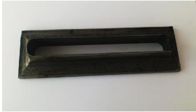
Figure II.16: Dispositif pour la découpe des spécimens
