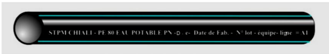
Figure II.5: Exemple de marquage d'un tube d'eau potable
