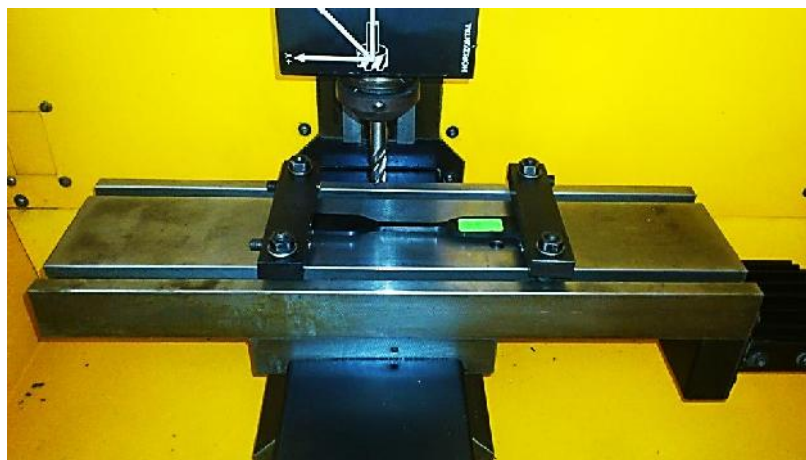
Figure II.19: Préparation des éprouvettes haltères
