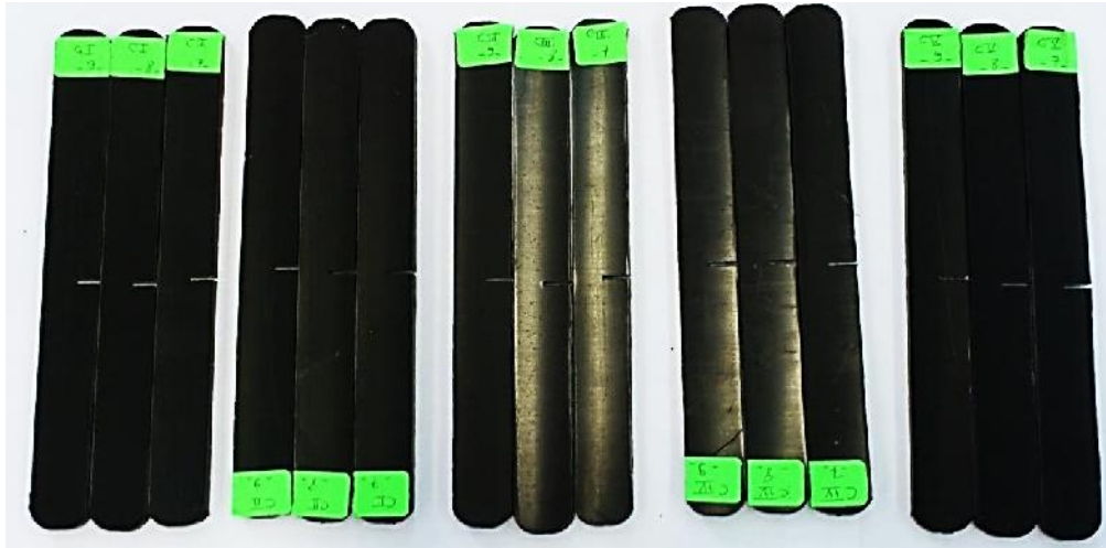
Figure II.18: Eprouvette SENT utilisée.
