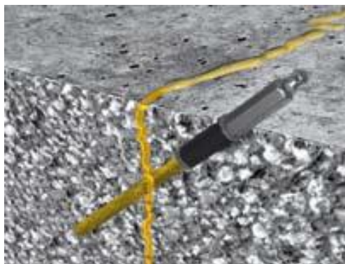
Figure IV.5 : Imperméabilisation des fissures
