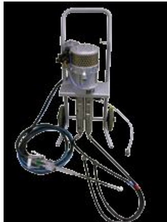
Figure IV.8 : pompe d'injection type PN-2C
