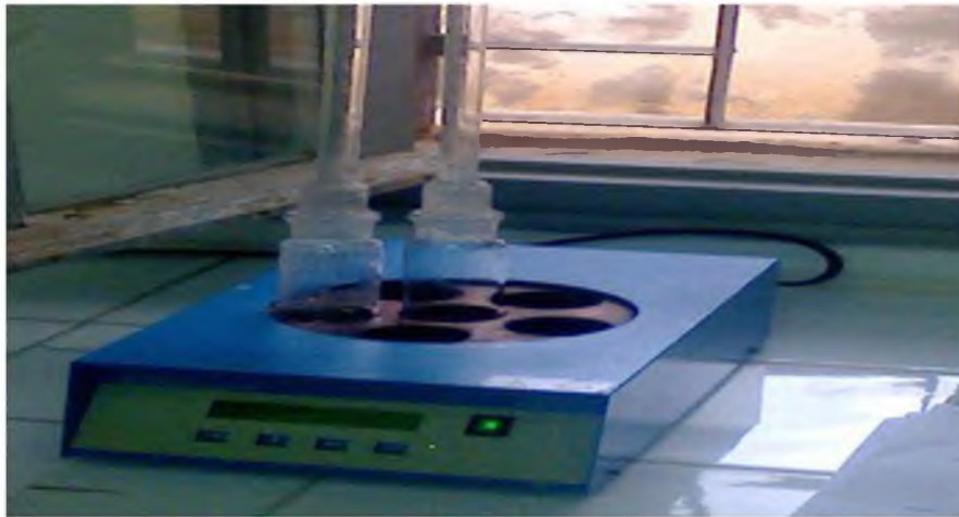
Figure (3.3) : Appareil photo de l'appareil de mesurer la D.C.O
