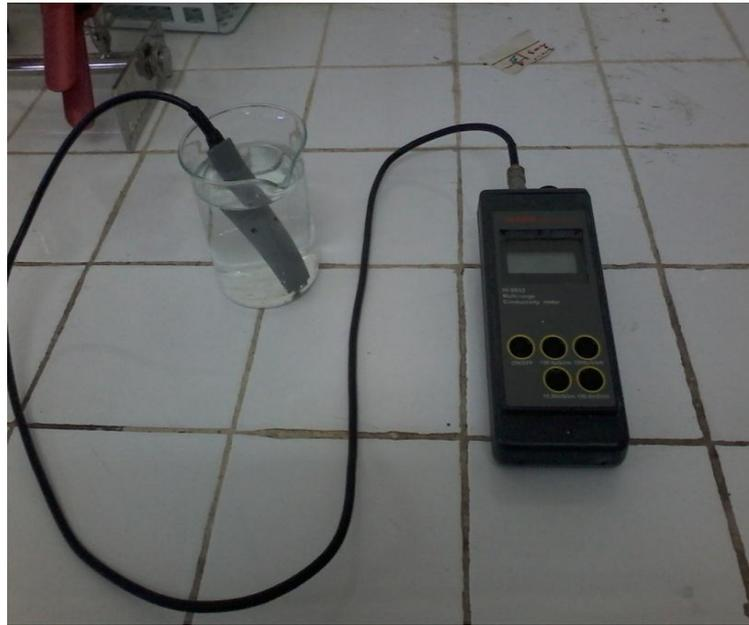
**Figure III-12 : Oxymètre**
