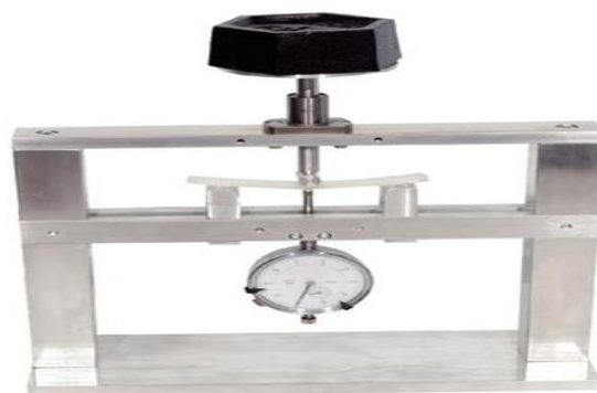
Figure II.21 : Portiques pour essais de flexion
