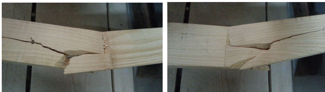
Fig. 3.1 : Rupture en flexion: fissure dans le bois
