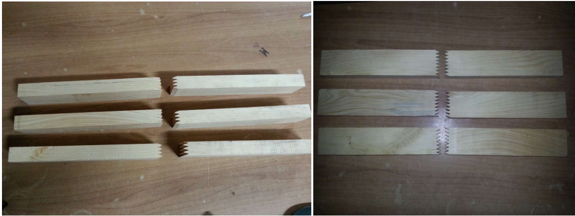
Figure 2.4 : les mi-échantillons avant collage et mise sous pression
