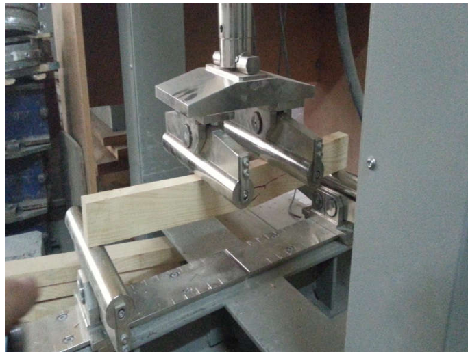
Figure 2.17 : Essai de flexion à 4 point.
