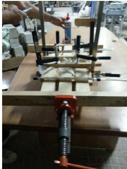
Figure 2.6 : Mise sous pression des échantillons
