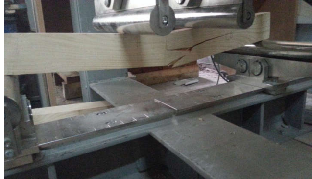
Figure 2.20 : Caractéristiques géométriques de la poutre test 3(avec entures à plat).
