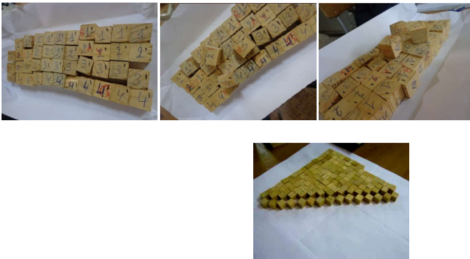
Figure 2.9 : Eprouvettes pour la mesure de la densité et teneur en eau.
