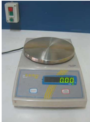
Figure 2.11 :Balance de précision de 0.01g.
