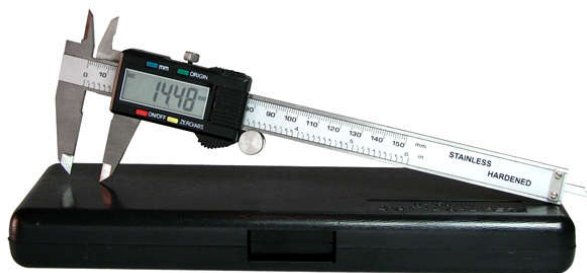
Figure 2.10 : Pied à coulisse à 0.01 [mm] de précision.
