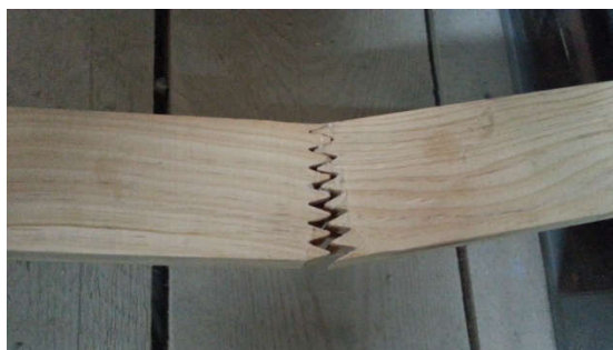
Fig. 3.2 : Rupture en flexion: Décollage total du joint
