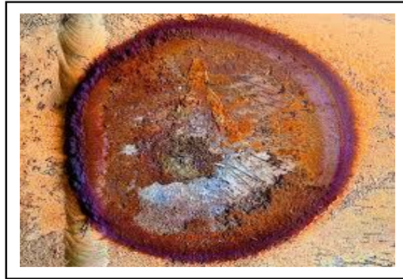
Figure I.5 : Corrosion par piqure
