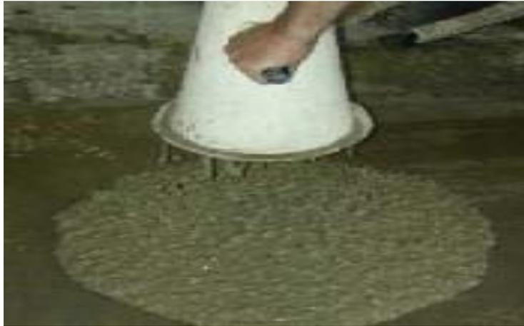
**Photo III-1:** Essai d'étalement [31]
