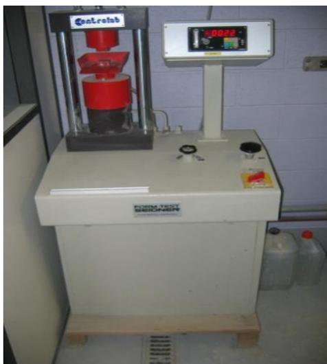
**Photo III-8:** Mesure de la résistance à la compression sur demi-prismes [4]
