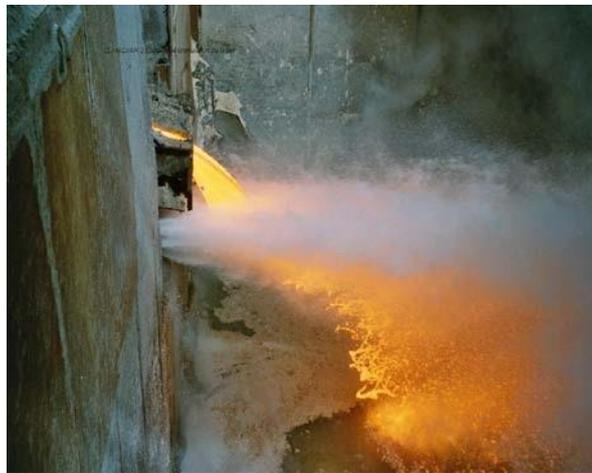
**Photo I-3** : Granulation du laitier de haut fourneau d'ELHADJAR [31]
