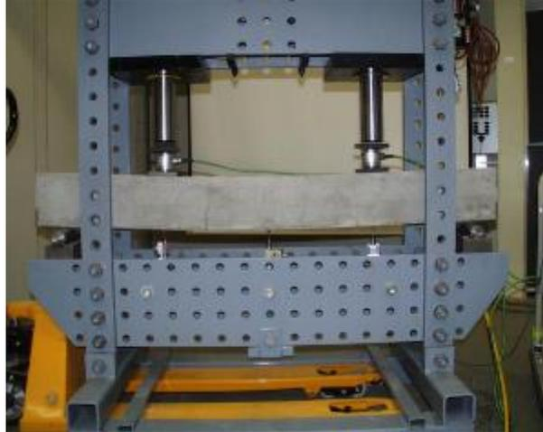
**Photo III-7:** Mesure de la résistance à la traction par flexion
