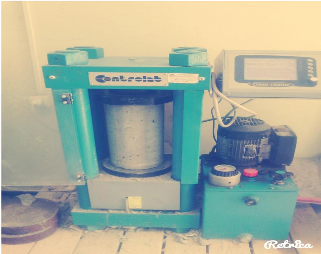
**Photo III-6:** Essai de compression Laboratoire NHC de l'Est, Belkheir-Guelma -
