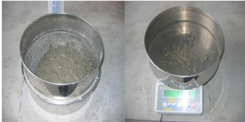
**Photo III-4:** Essai de stabilité de tamis [4]
