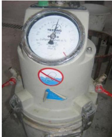
**Photo III-5:** Aéromètre à béton [16]
