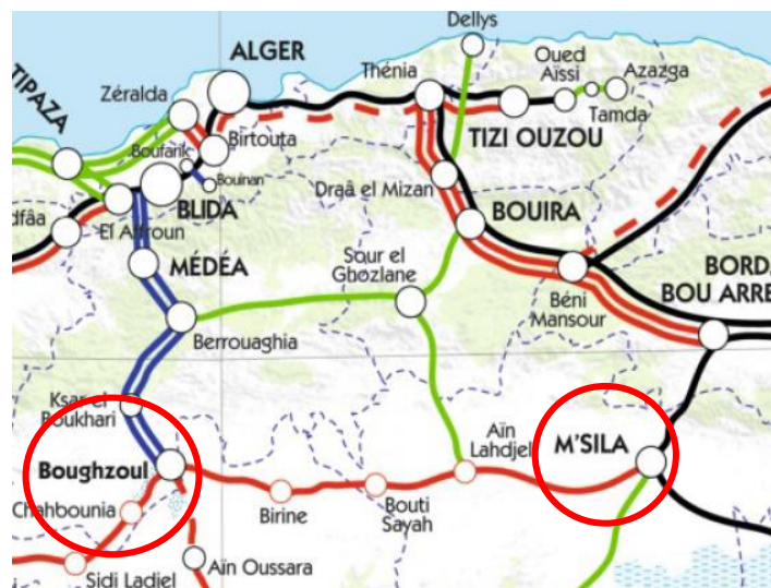
Figure 9 : tracé de ligne ferroviaire M'Sila - Boughezoul
