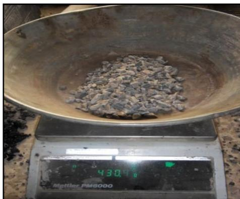
Figure 4.18. Le résultat de la pesée après le séchage de l'échantillon.
