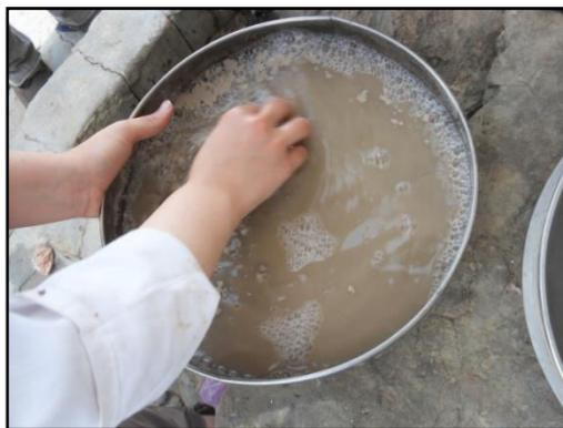
Figure 4.20. Le lavage de l'échantillon au tamis de 0.080mm.
