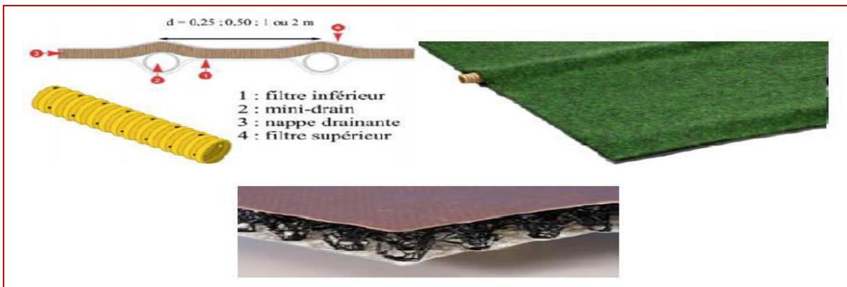
Figure 3.8. Structure géocomposite.
