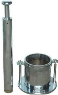
Figure 1.15. Moule Proctor et dame Proctor
