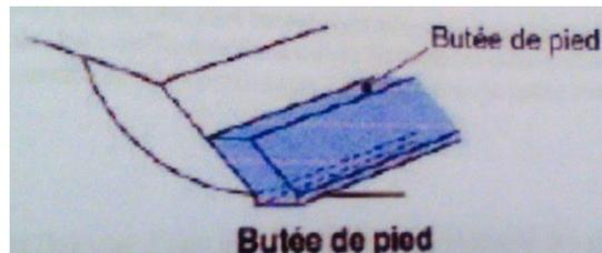
Figure 2.13. Chargement au pied d'un talus.
