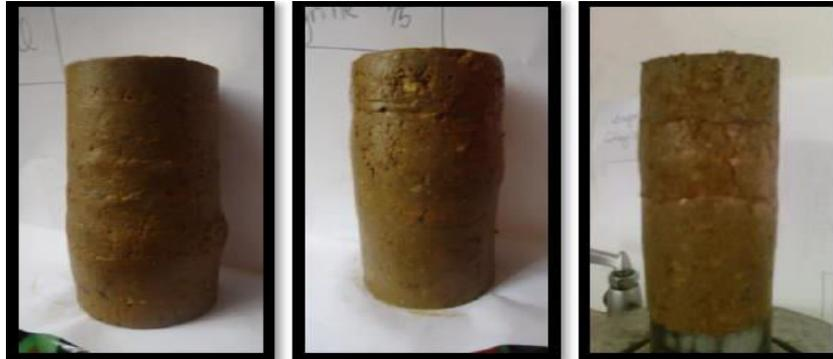
Figure 3.19. Déformation des éprouvettes.
