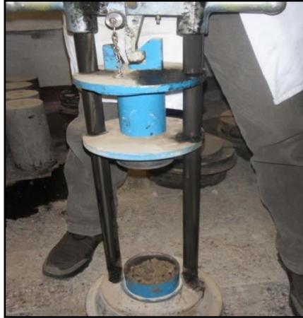
Figure 4.13. Appareil de la fragmentation dynamique.
