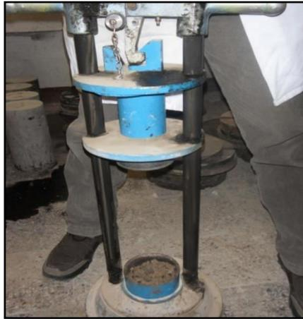
Figure 4.13. Appareil de la fragmentation dynamique.
