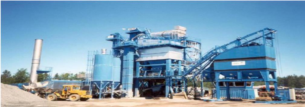
Figure 4.4. Central des enrobés bitumineux pour le recyclage à chaud.
