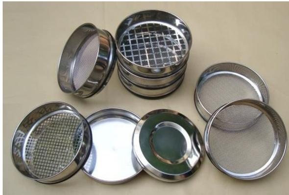
Figure 1.2. Batterie de Tamis selon les différents refus
