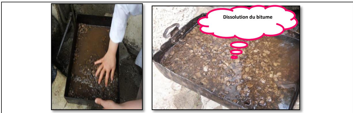
Figure 4.11. Opération de lavage de fraisât avec savon liquide.
