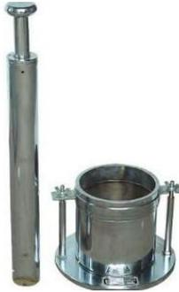
Figure 1.15. Moule Proctor et dame Proctor
