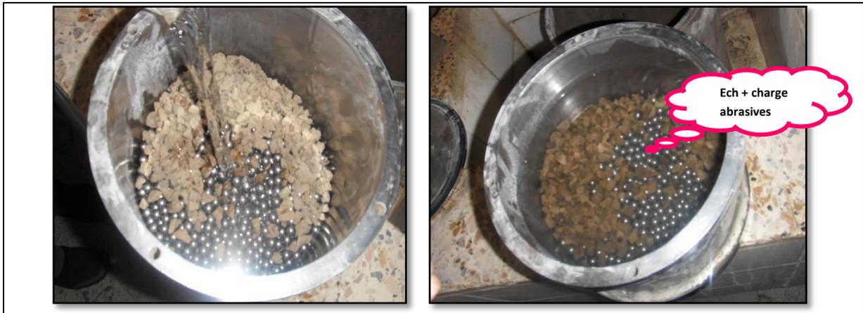
Figure 4.15. Echantillon + les boulets, et l'eau dans le tambour.
