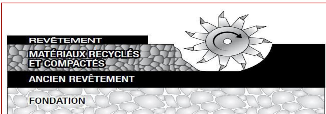
Figure 4.5. Réutilisation des enrobés bitumineux recyclés à froid.
