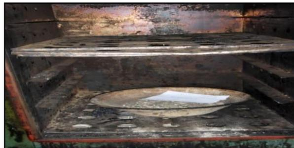
Figure 4.21. Mettre l'échantillon dans l'étuve à la température spécifiée.
