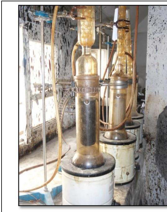
Figure 4.25. L'essai d'extraction à l'appareille KUMAGAWA.
