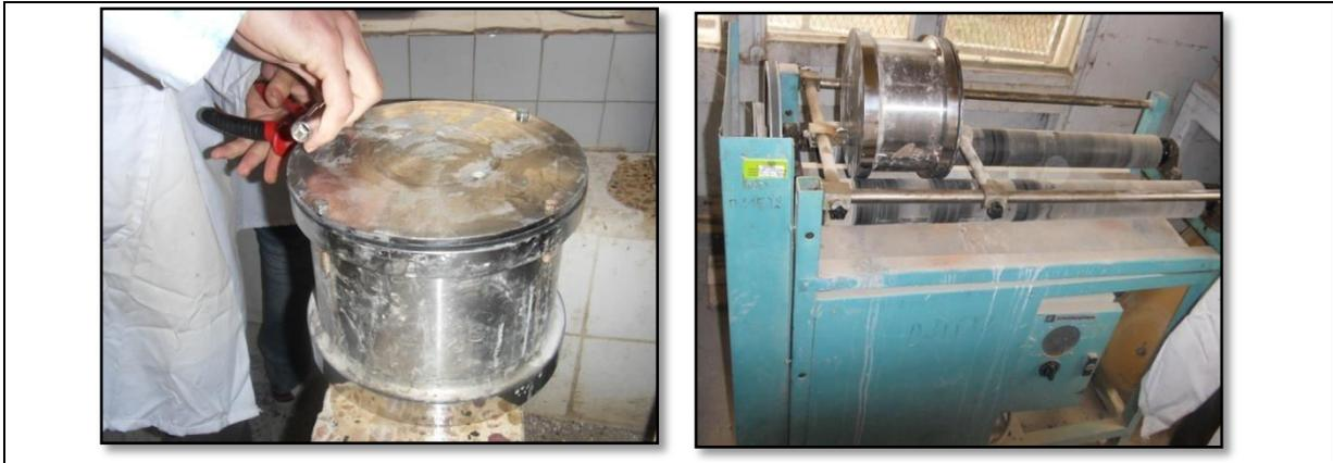
Figure 4.16. Préparation du tambour pour essai et la mise en place dans l'appareille M.D.E
