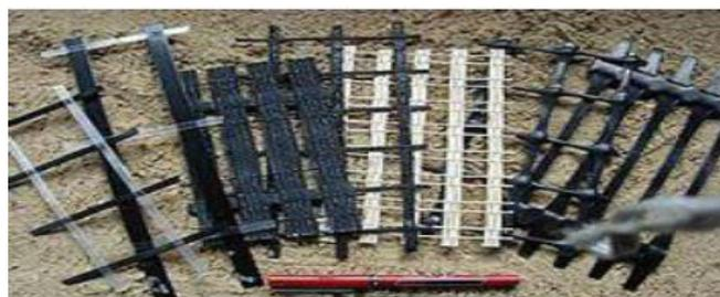
Figure 3.9. Échantillons de géogrilles
