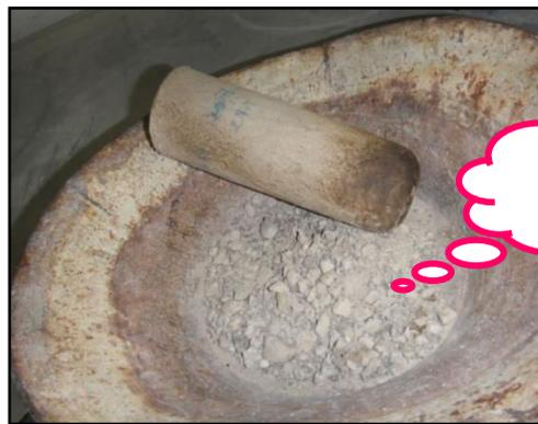
Figure 4.19. L'échantillon préparé pour granulométrie .
