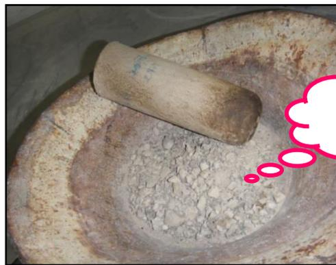
Figure 4.19. L'échantillon préparé pour granulométrie .
