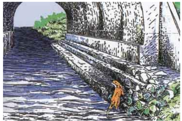
Figure III-08 : passage pour faune
