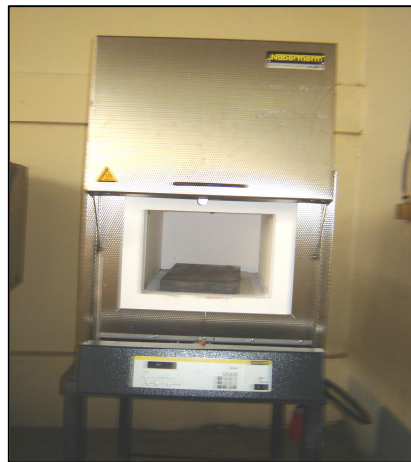
Figure II.3 : Four à chambre électrique pour le traitement thermique des éprouvettes
