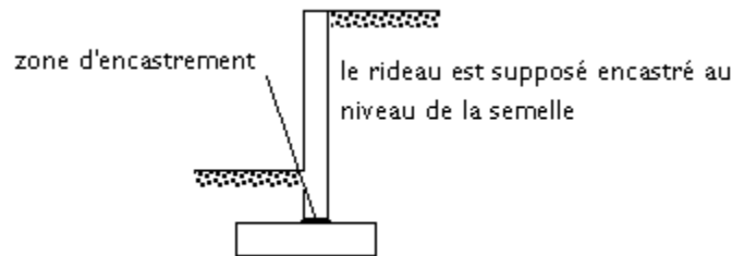
Figure 3.11. Schéma statique du rideau.
