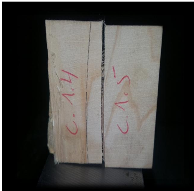
Fig. III.6 : Rupture dans la colle (colle1).
