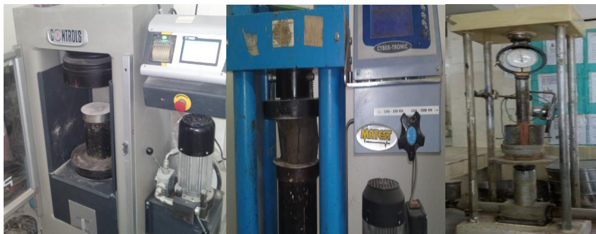
Photo 5- 8 : les machines utilisai pour la Compression simple_ laboratoire (LTPE.Annaba)
