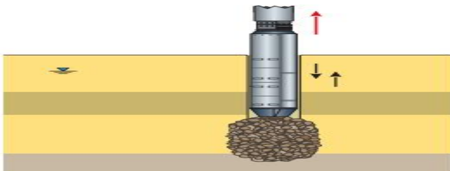
Figure 3-12 : Compactage ( www. Kellerfrance.com/technique/procèdes/colonnes ballastées ).
