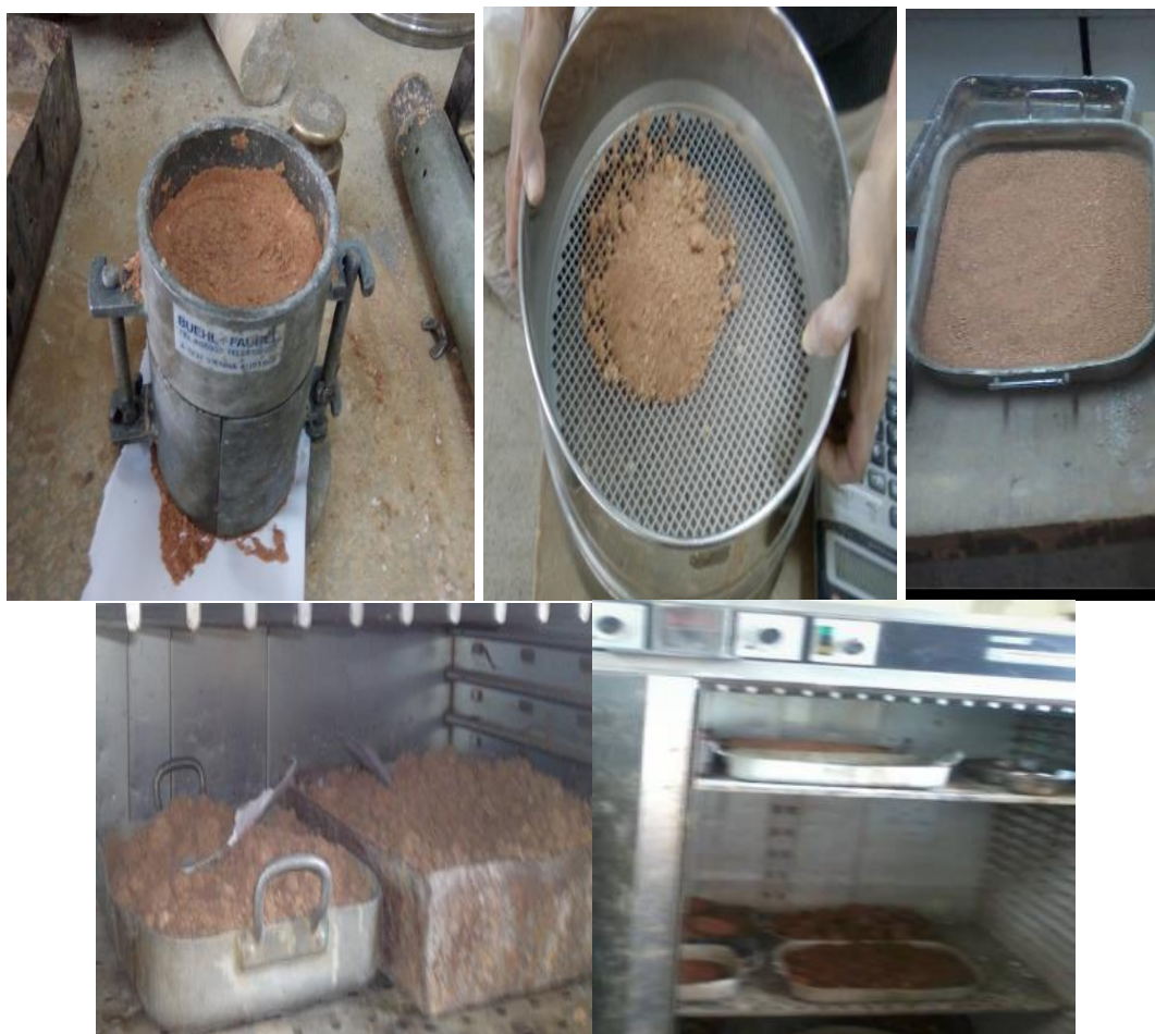
Photo 5- 5 : l'essai proctor pour sol B sans additives _ laboratoire (LTPE.Annaba)
