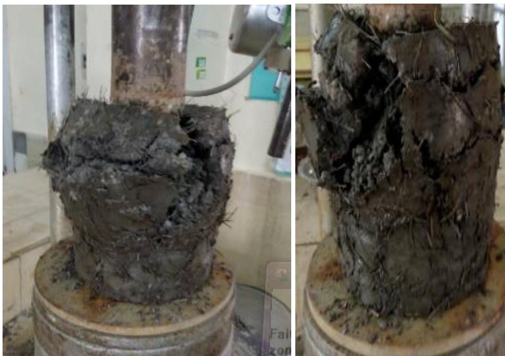
Photo 5- 9 : la déformation de Sol A avec des fibres plastique après la compression laboratoire (LTPE.Annaba)
