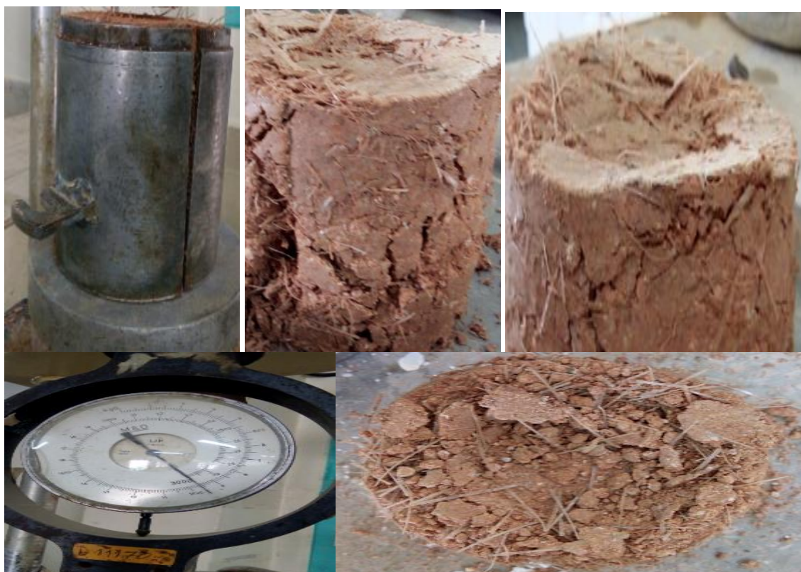
Photo 5-10 : la déformation de Sol B avec plastique après la compression laboratoire (LTPE. Annaba)
