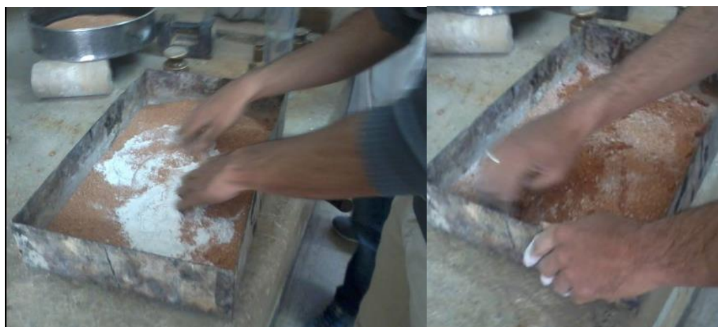
Photo 5-6 : l'essai proctor pour sol B avec la chaux_ laboratoire (LTPE. Annaba)
