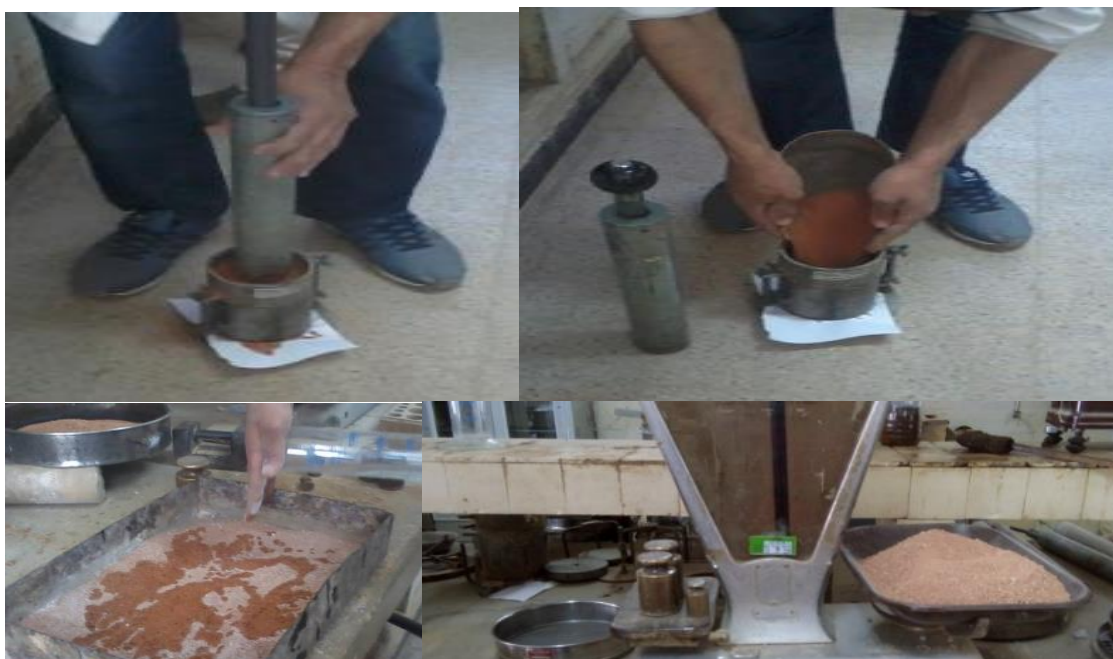
Photo 5- 1 : Essais de compactage dans laboratoire ( LTPE .Annaba)
