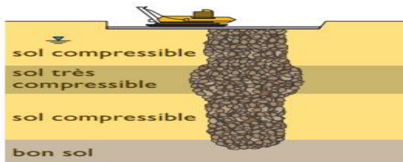
Figure3-13: Finition( www. Keller-france.com/technique/procèdes/colonnes ballastées ).
