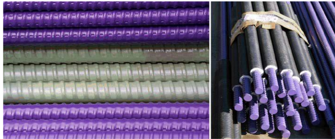
Figure I.19 - Barres d'acier avec revêtement époxy gris et violet (gauche) et partiellement encapsulés par gaine ondulée (à droite)
