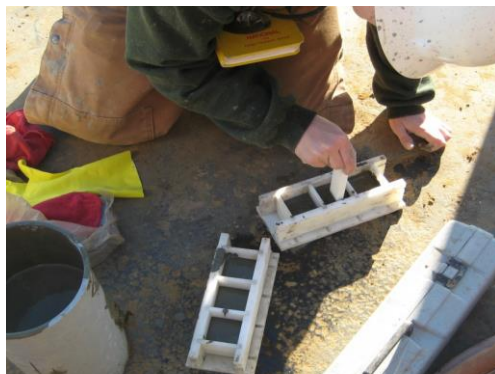
Figure I.30 - Préparation des cubes de coulis pour le test
