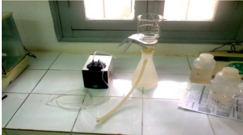
Photo (1-13) : Filtre à pompe
