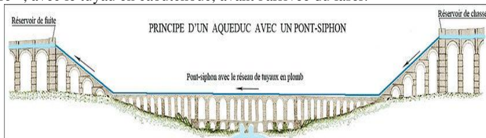
Figure (1.3) : Principe d'un aqueduc avec pont-siphon comprenant : le réservoir de chasse, le réservoir de fuite et les tuyauteries en plomb sur les rampants.
