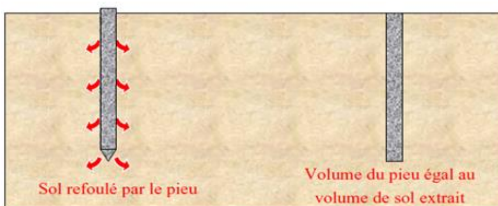
Figure II. 7: Pieu à refoulement et sans refoulement.
