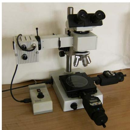
**Figure III.4 :** Microscope optique pour la mesure de l'usure.
