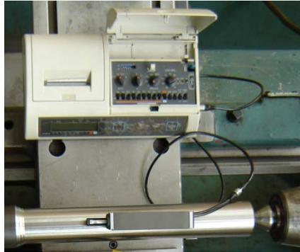
Figure III.6 : Rugosimètre type SurfTest 301 MITUTOYO
