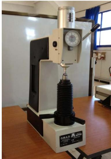
Figure III.9 : Duromètre type 206RT
