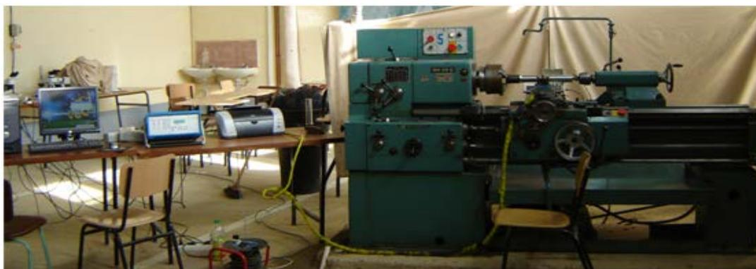
Figure III.1 : Tour à chariotier et à fileter modèle SN40.
