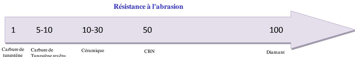
**Figure I.1 :** Échelle comparative de résistance à l'abrasion
