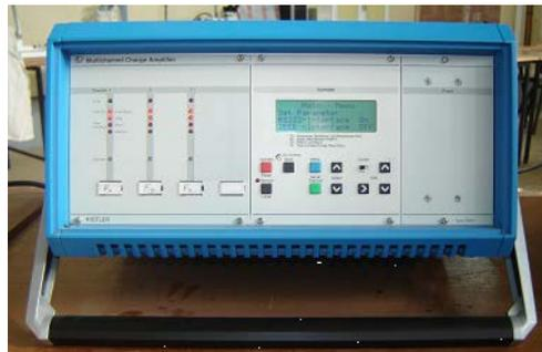
Figure III.7 : Amplificateur de charge Kistler 5019B à trois canaux.
