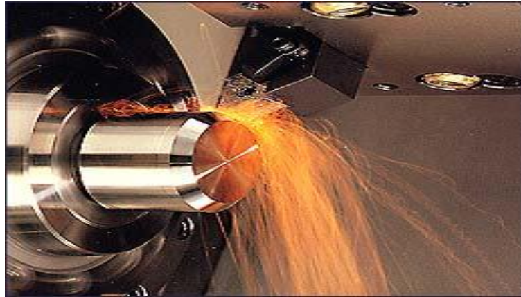
Fig. I.2. Opération d'usinage avec un outil en CBN [8]
