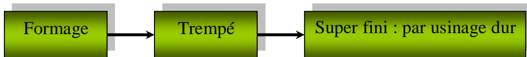
Fig. I.3. Cycle de production des bagues des roulements des roues dentées des cames obtenues respectivement par (a) et (b) [6]
