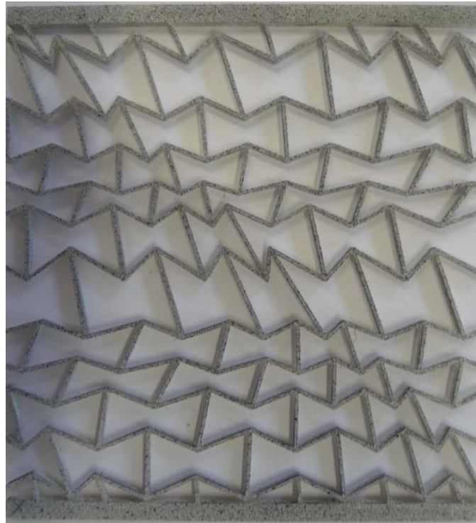
Figure IV.2. Configuration Voronoï auxétique a coefficient de Poisson négatif créé pour \Phi = 0 et \Psi = \pi/4 .
