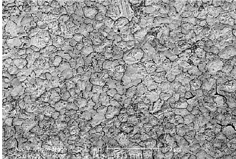
Figure II-6 Structure austénitique de l'acier AISI H11 [45]
