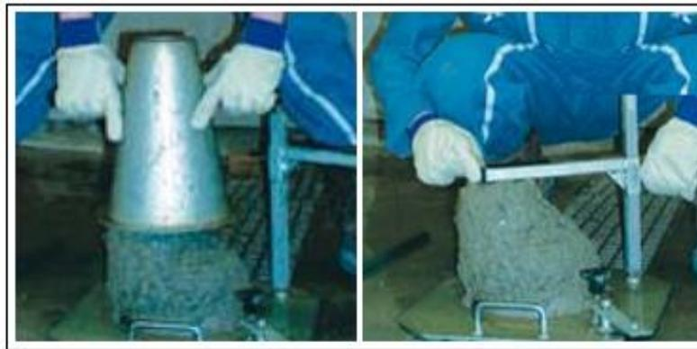
Fig. II.7: Exemple de l'affaissement au cône d'Abrams.
