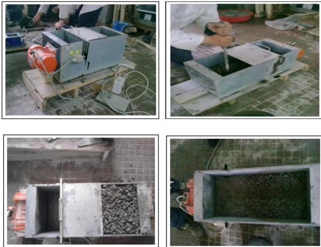
Photos. III.12 : Etapes de la conduite de l'essai du maniabilimètre du LCPC.
