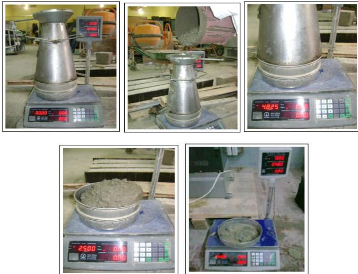
Photos. III.8 : Etapes de la conduite de l'essai de stabilité au tamis utilisé.
