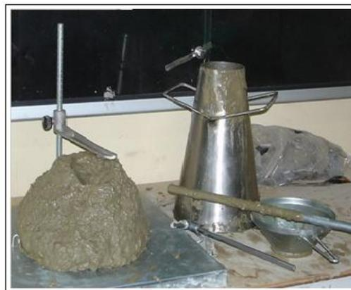
Photos. III.11 : Etapes de la conduite l'affaissement au cône d'Abrams.
