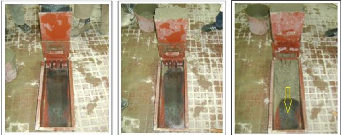
Photos. III.10 : Etapes de la conduite de l'essai de la boîte en L utilisé.
