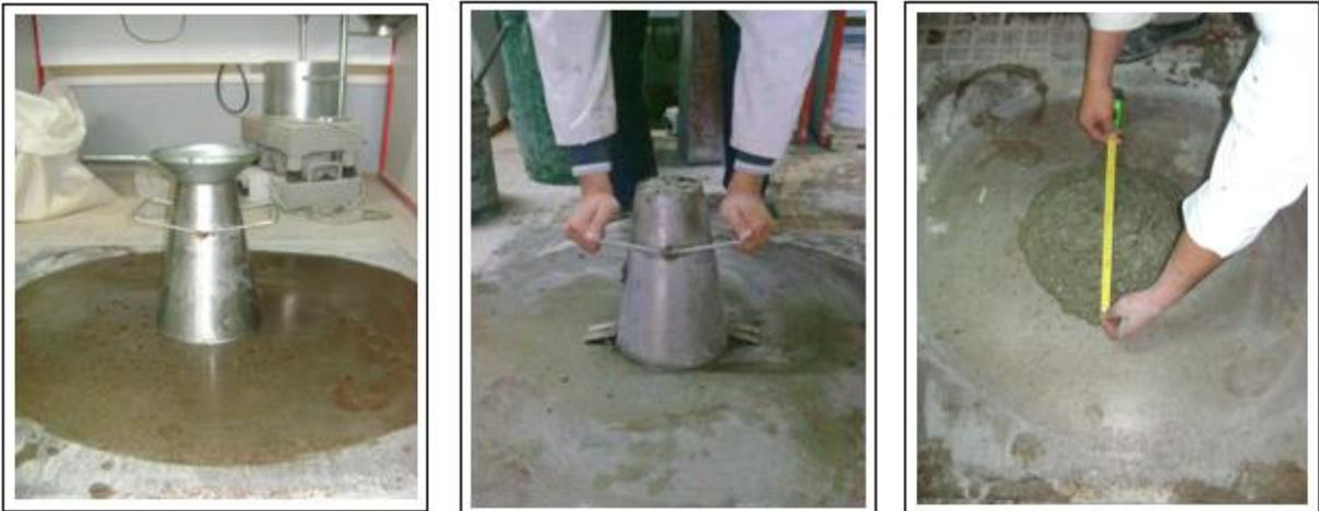
Photos. III.9 : Etapes de la conduite de l'essai d'étalement utilisé.
