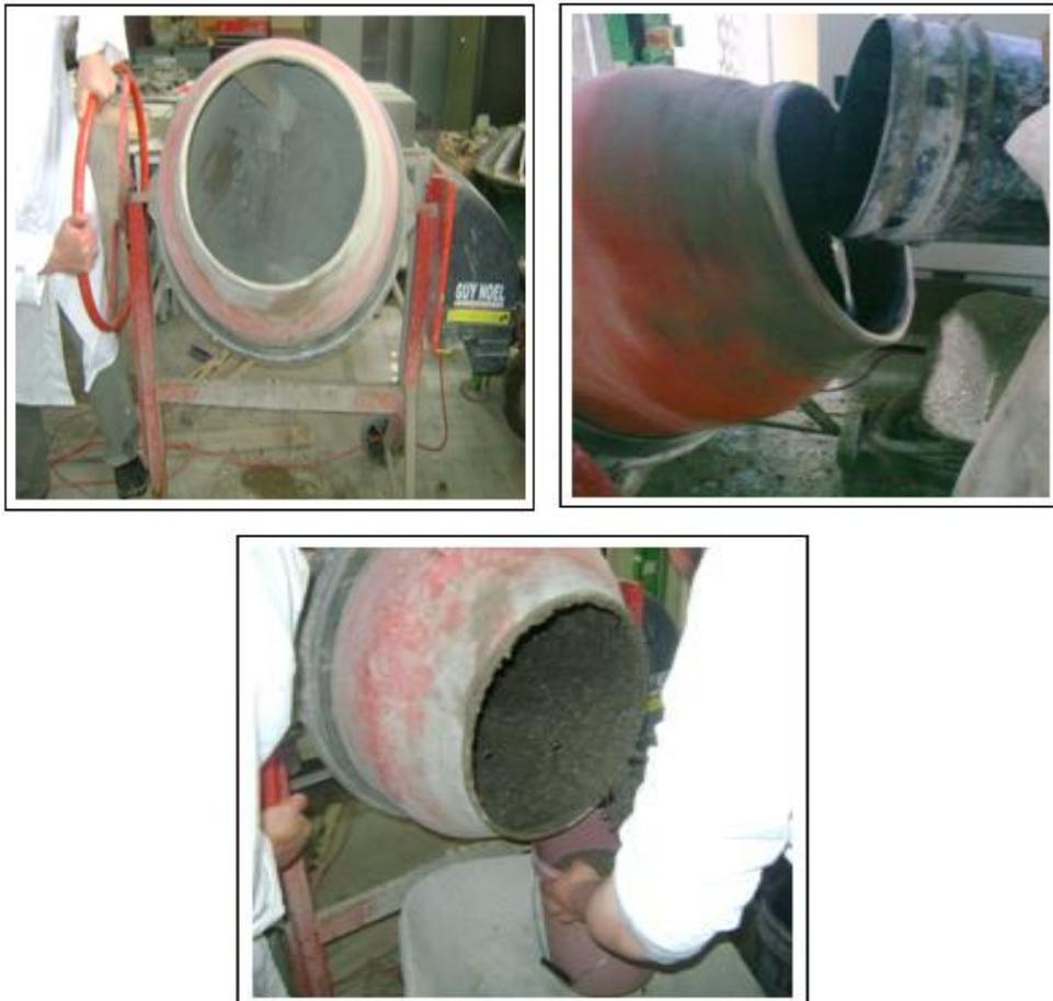
Photos. III.7 : Les étapes de fabrication des bétons étudiés.
