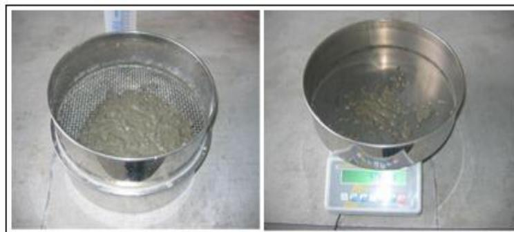
Fig. II.19: Essai de stabilité au tamis.
