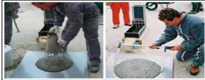
Fig. II.14: Exemple d'étalement d'un BAP.
