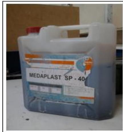
Photo. III.4: Le superplastifiant utilisé.
