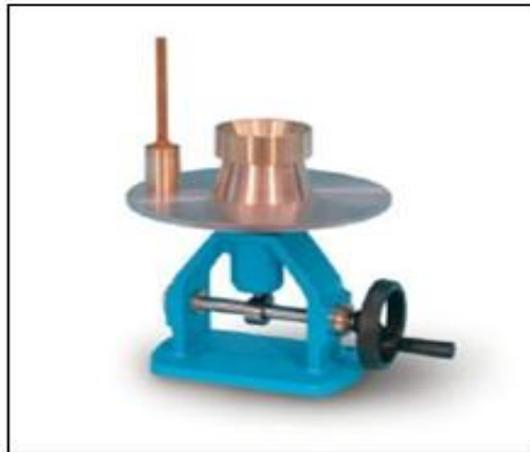
Fig. II.1: Table à secousse.
