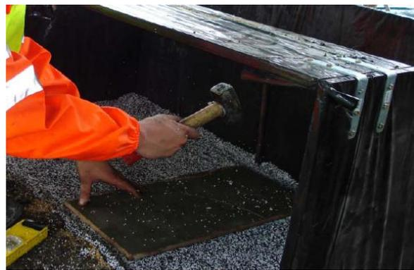
Figure 62 : Deuxième étape de compactage du matériau
