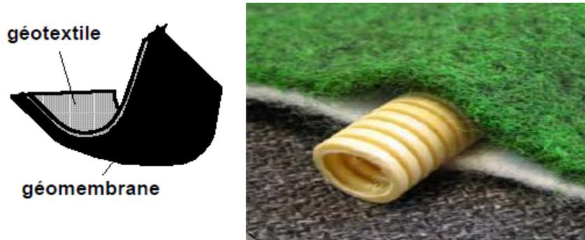
Figure 8 : la structure d'un géocomposite
