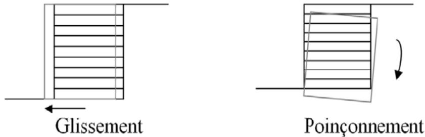
Figure 49 : Mécanismes de ruine par glissement et par poinçonnement d'un ouvrage
