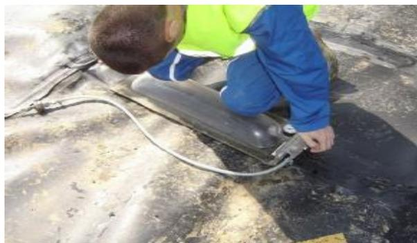
Figure 36 : Contrôle des géosynthétique au laboratoire
