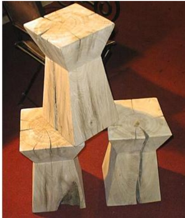
Figure I-5: fissures radiales de retrait
