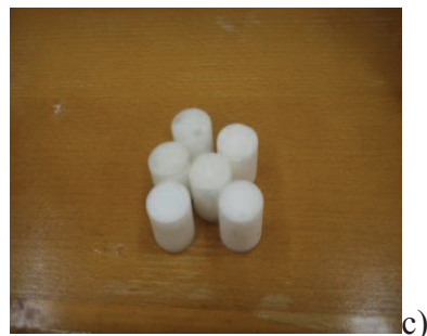
Figure 2.3. a) et b) coupoirs de diamètres (19;22;28), c) échantillons prélevés, d) pièces étalons pour l'essai de traction.
