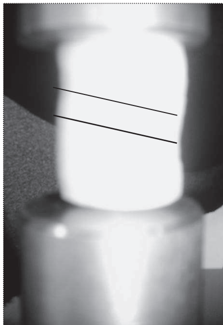
Figure 2.12. Mécanisme de déformation montrant la bande d'effondrement.
