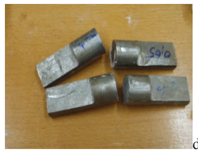
Figure 2.3. a) et b) coupoirs de diamètres (19;22;28), c) échantillons prélevés, d) pièces étalons pour l'essai de traction.
