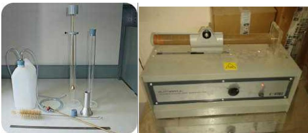
Figure 19 : Photo du matériel utilisé pour l'essai équivalent de sable
