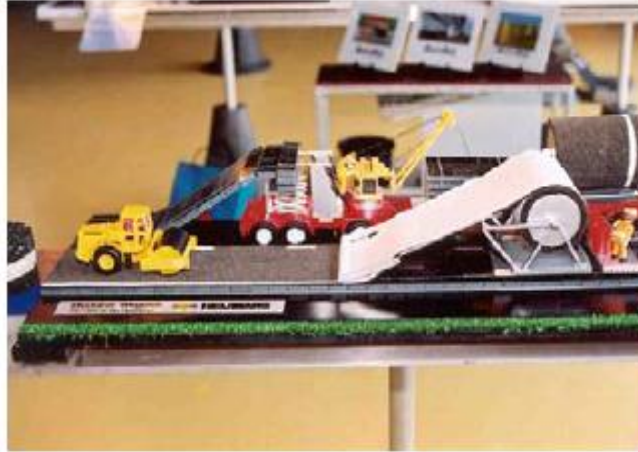
Figure 6 : Maquette de l'installation d'une route enroulable
