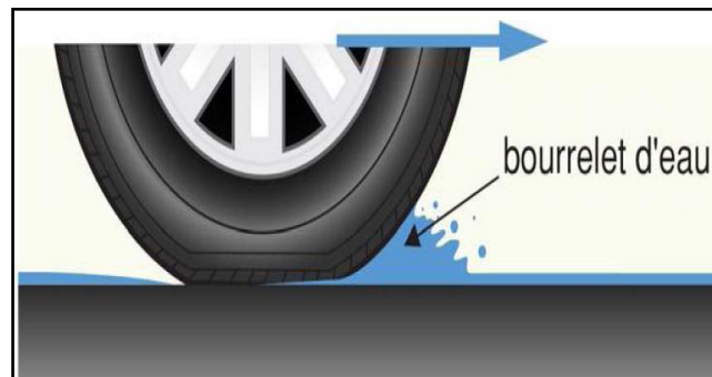
Figure 24 : Le bourrelet d'eau à l'origine de l'hydroplanage
