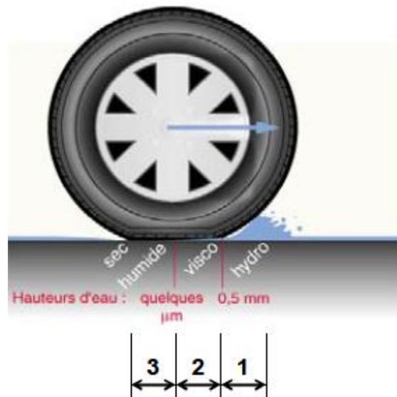
Figure 21 : Description de l'aire de contact pneumatique/ chaussée
