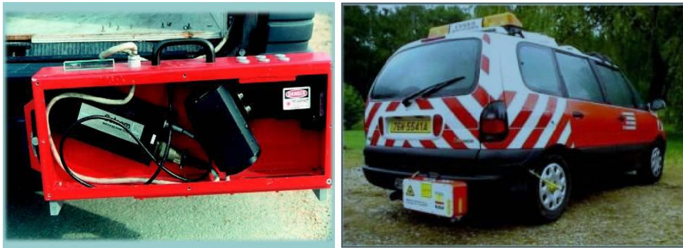
Figure 30 : Méthode profilométrique (Rugolaser)
