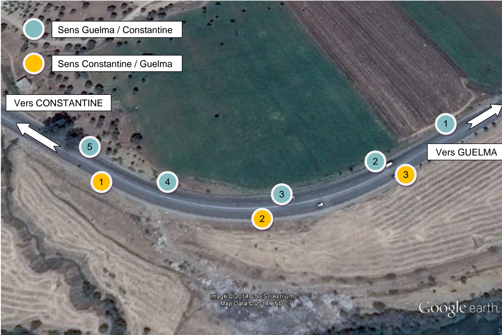
Figure 63 : Positions des essais sur la RN20 (2 ème campagne d'essai)
