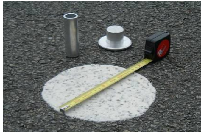
Figure 28 : Mesure de la macrotexture PMT
