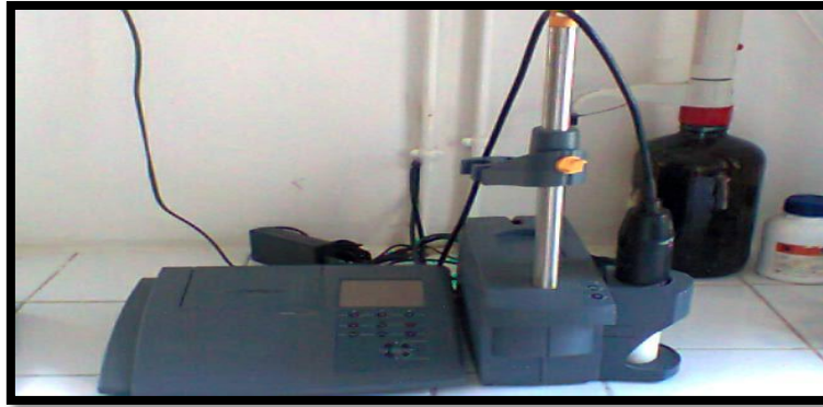
Figure 42: Installation pour mesurer la DBO 5
