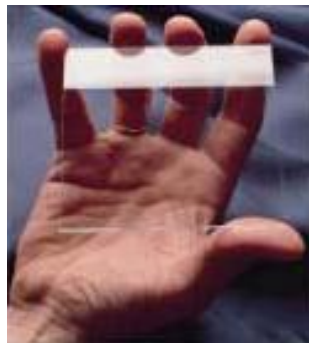
Fig.20 : Verre de vitre avec un revêtement sol-gel poreux anti-réflexion en haut et sans revêtement en bas.
