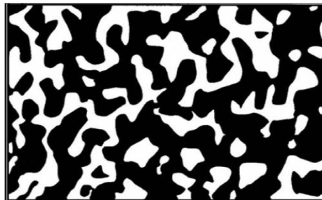
Figure 1.16 Squelette Microstructure du matériau FGM (Vel et Batra 2002)
