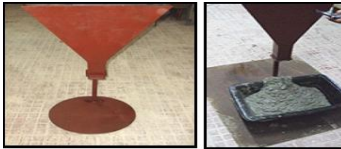
Figure III.12: Mesure du temps d'écoulement du B 5
