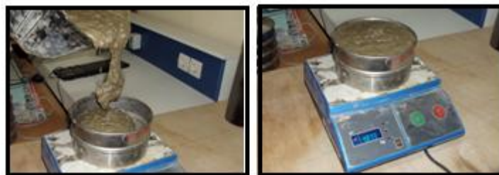
Figure III.11 : photos illustrant l'essai de stabilité au tamis
