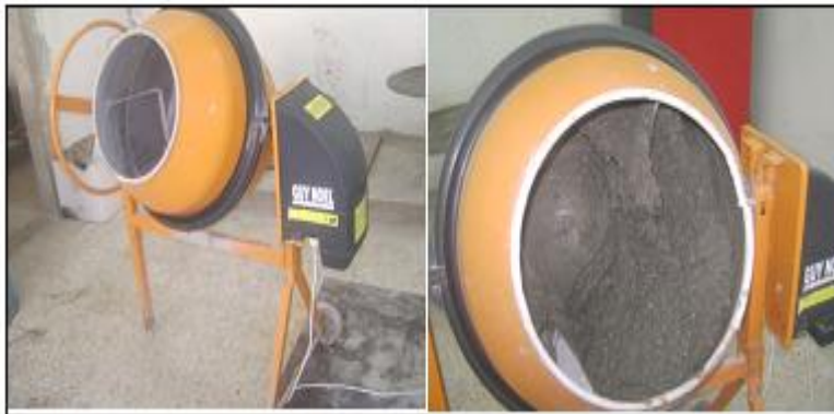
Figure IV.1 : Malaxage du béton
