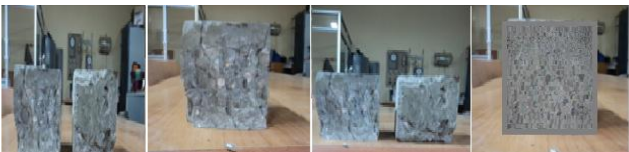
Figure IV.8 : Processus de rupture des éprouvettes en compression pour le BAP-HP 5
