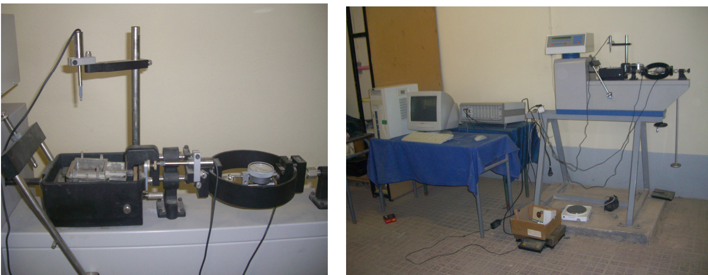
Fig. 4.4 Vue générale de l'appareil de cisaillement
