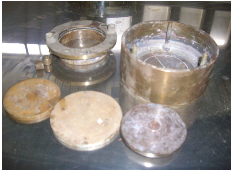
Fig. 4.2 Vue de la cellule œdométrique avec ses accessoires
