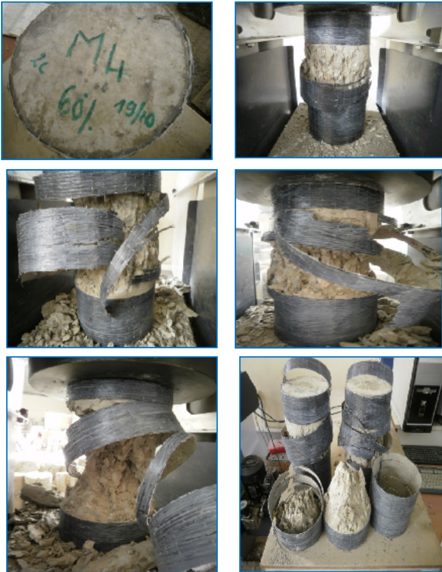
Fig. III.14 Eprouvettes prés chargées à (60%) puis renforcées par TFC(deux couches)
