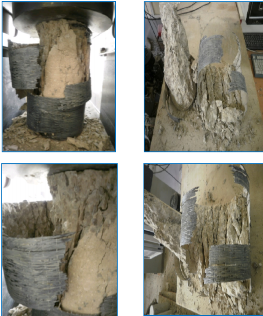
Fig.III.15 Eprouvettes prés chargées à plus de (80%) puis renforcées par TFC
