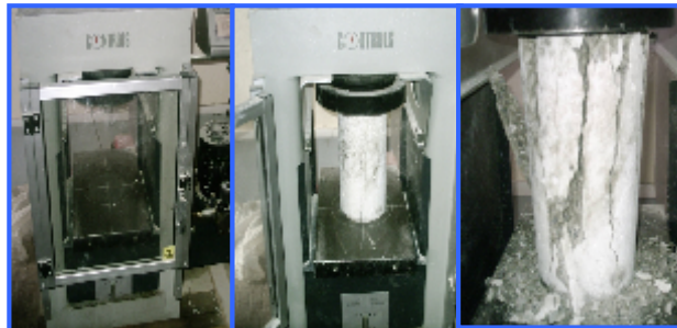
Fig. II.10 : essais de compression
