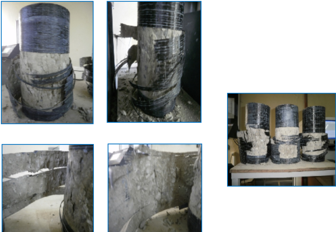
Fig. III.11 Eprouvettes prés chargées à (30%) puis renforcées par TFC Une seule couche
