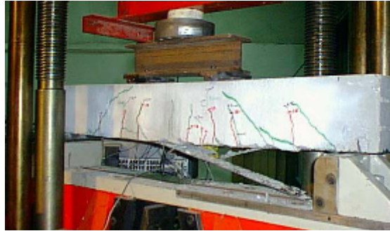
Fig.I. 19 : décollement du renfort - le peeling-off-
