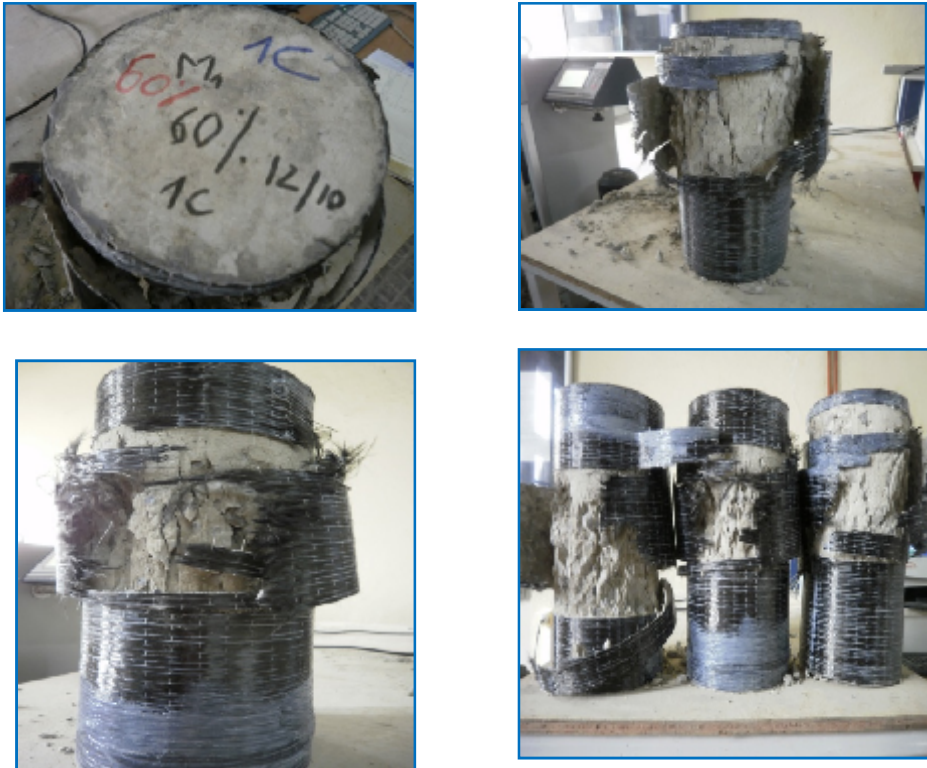
Fig. III.13 Eprouvettes prés chargées à (60%) puis renforcées par TFC (une seule couche)
