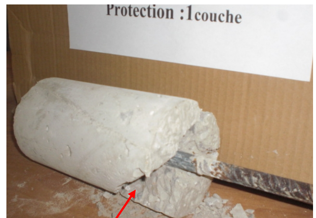
Arrachement d'un cône et destruction de l'échantillon
