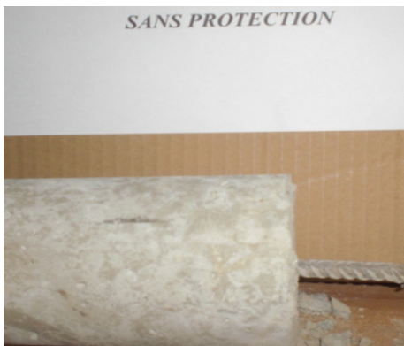
Surface extérieure non fissurée
