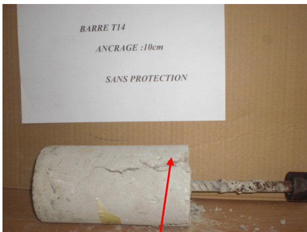
Fissure épaisse et profonde sur la longueur d'ancrage
