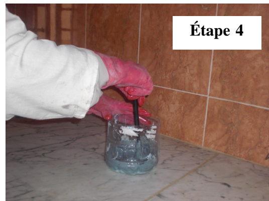
4 - Faire mélanger l'ensemble (résine +durcisseur) dans un récipient avec une tige rigide
