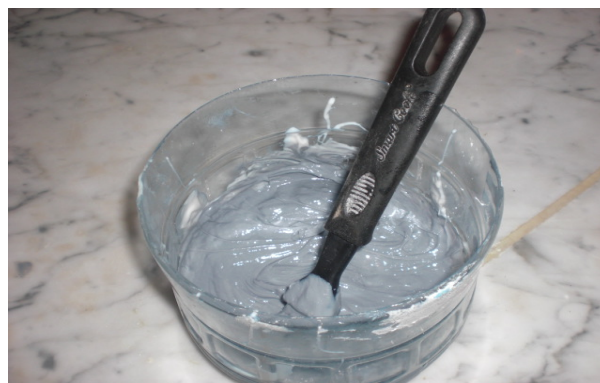
5-Mélanger jusqu'à obtenir une pâte grise claire : c'est la colle finie
