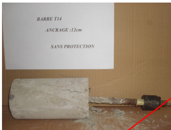
Fissure épaisse le long de l'ancrage seulement
