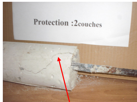
Fissure apparente le long de l'ancrage
