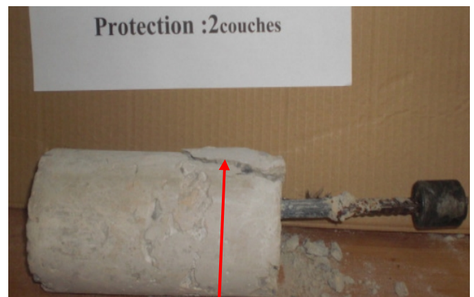
Arrachement d'un morceau de béton
