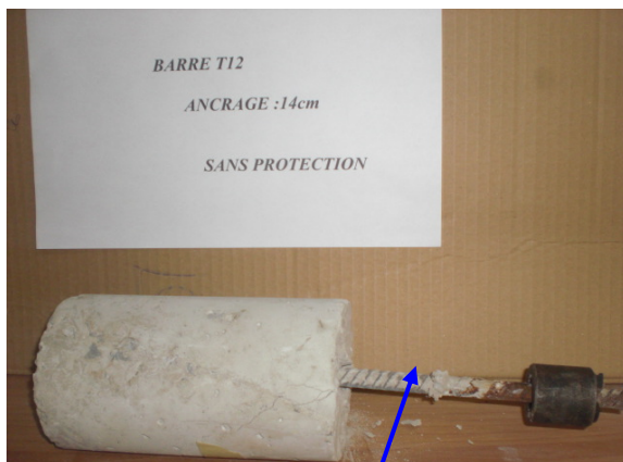
Barre recouverte d'une couche fine de beton
