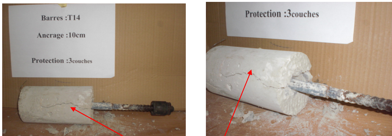
Fissure apparente le log de l'ancrage
