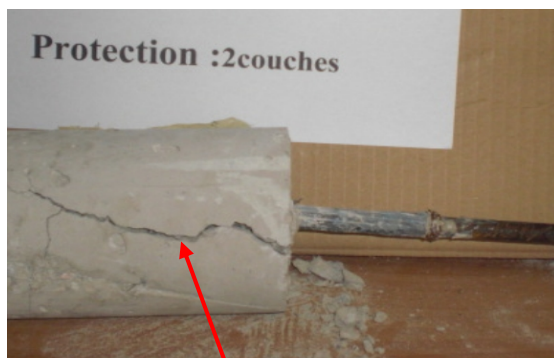
Fissure profonde, seulement sur la longueur d'ancrage
