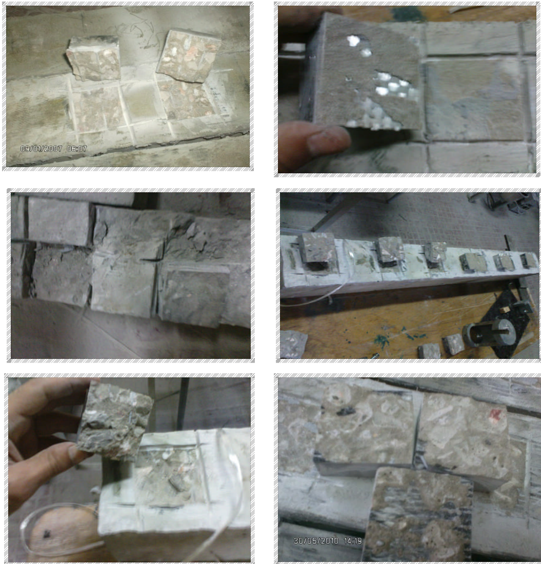
Figure II.15. Rupture de la réparation (couche de renforcement)
