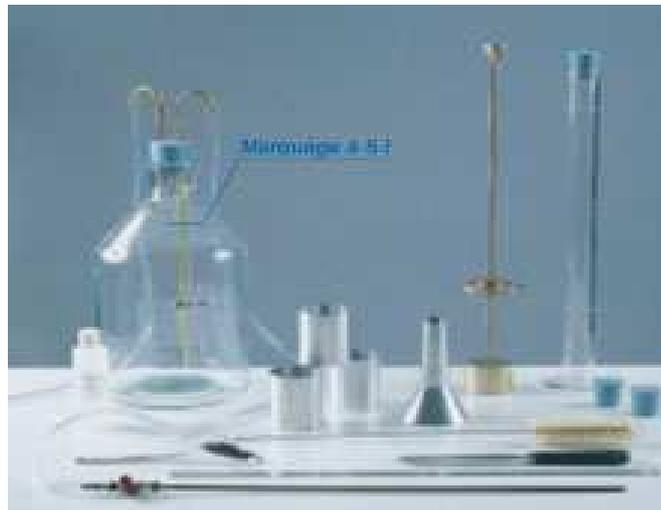
**Figure II-1:** Appareillage de l'équivalent de sable
