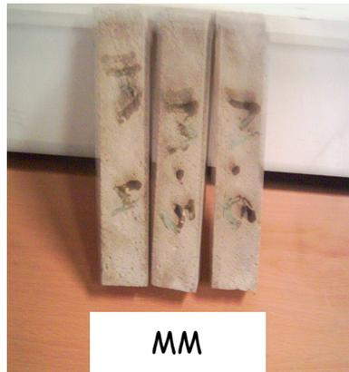
**Photo V-1 :** Mortier MM à 600°C
