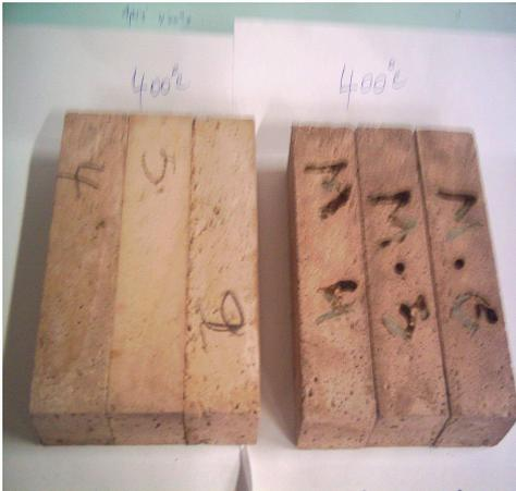
**Photo V-1:** Mortier MM à 400 °c
