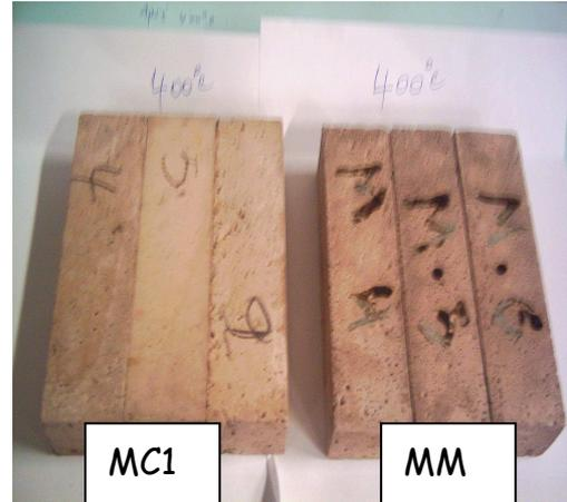
**Photo V-2** Mortier MC1 à 400° et MM
