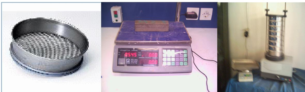
**Figure II-2:** 1-tamis ; 2- balance ; 3-tamiseuse électrique
