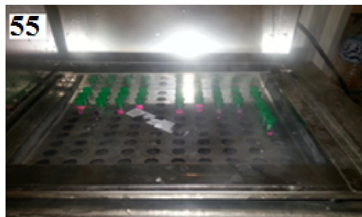
Photo 55 et 56: Placement des tubes dans le bain marie à 100°C pendant 10 min.
