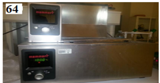
Photo 63 et 64: Placement des tubes dans le bain marie à 100°C pendant 20 min.
