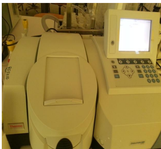
Photo 70 : Mesure de l'absorbance par spectrophotomètre Thermo Scientifica à 570 nm.
