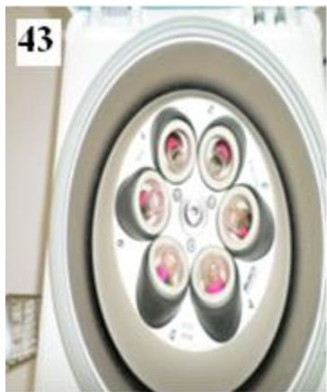
Photo 43 et 44 : centrifugation à 5000 g pendant 10 min, à 4°C. Photo 45 : Récupération de surnageant 01.
