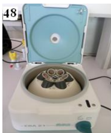
Photo 48 : Centrifugation à 5000 g pendant 10 min, à 4°C. Photo 49 : Récupération de surnageant 2. Photo 50 : Filtration de surnageant 1 et 2.
