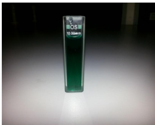
Photo 79 : Mélange de surnageant et réactif de Bradford.
