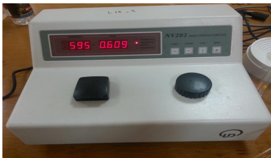
Photo 81 : Lecture de l'absorbance par le spectrophotomètre NV202 à 595 nm.
