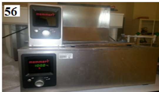
Photo 55 et 56: Placement des tubes dans le bain marie à 100°C pendant 10 min.
