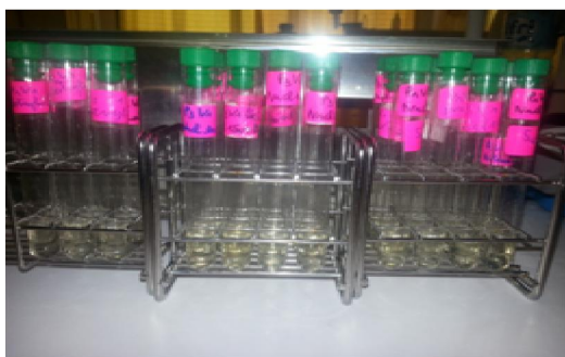
Photo 61 : Addition de mélange réactionnel ninhydrine-acide ascorbique.
