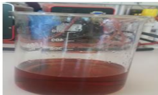
Photo 52 : Addition de 5 ml de réactif à l'anthrone.
